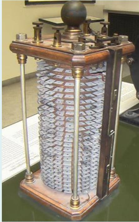
Primjerak Gaulard-Gibbsovog transformatora proizvedenog 1884. godine (Museo Galileo, Florence, Italija)
