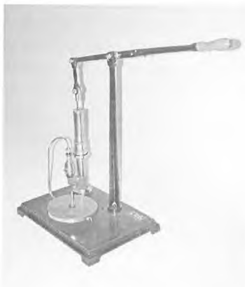
Slika 2. Zračna crpka "Geryk" iz 1902. godine (Tehnički muzej, Zagreb, podaci D. Fulanović)
