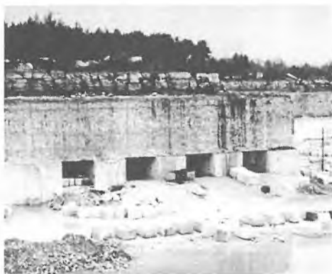
Slika 4. Podzemna eksploatacija arhitektonsko-građevnog kamena u kamenolomu Kanfanar
