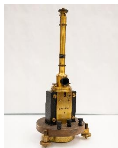
Sl. 5. Zrcalni galvanometar u ponudi tvrtke Siemens&Halske 1906. godine i instrument u Središnjoj knjižnici FER-a
