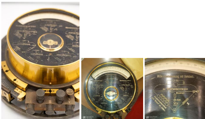
Sl. 9. Univerzalni galvanometar korišten kao Wheatstoneov most na I vježbi kod Josipa Lončara iz predmeta Električna mjerenja (EM) u ak. godini 1938./1939. a) vanjski izgled, b) pogled s gornje strane, c) spoj instrumenta kao Wheatstoneov most za I. vježbu iz EM
