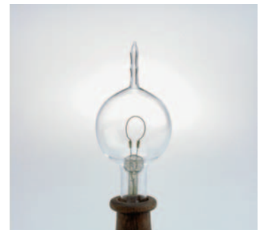
Prva Edisonova žarulja s ugljenom niti (pougljena nit bambusa), u usporedbi s lučnicama, slabo je svijetlila
