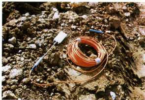
Foto 6. Čelija за mjerenje totalnog pritiska
