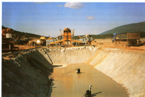
Foto 2. Postrojenje za pročišćavanje isplake BE 500 s bazenom za radnu isplaku
