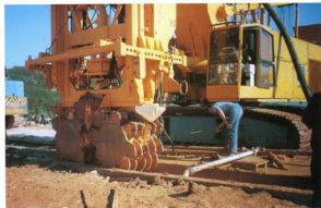
Foto 5. Kotači sa zubima hidrauličkog rezača
