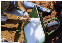
Foto 4. Priprema čelije za mjerenje pritiska porne vode prije ugradnje
