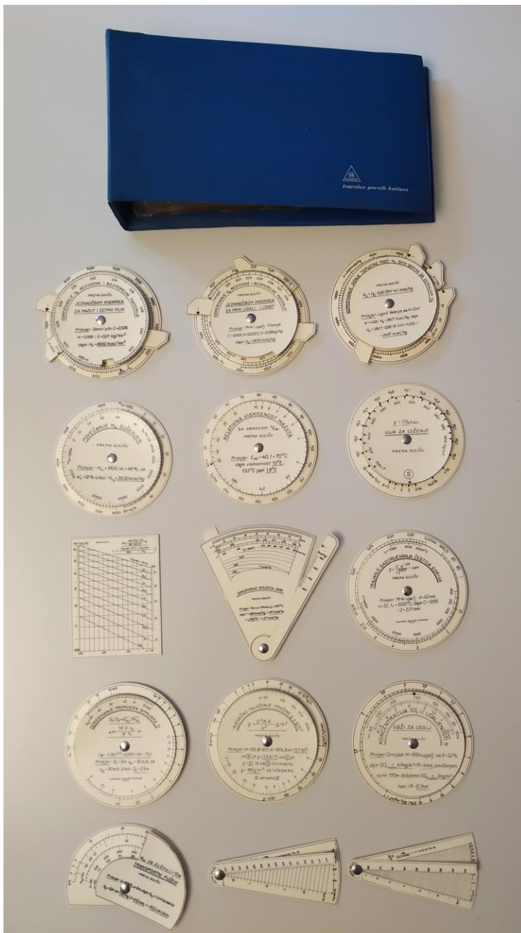
Sl.1. Komplet od 15 analognih računala za proračun izgaranja u ložištima parnih kotlova
