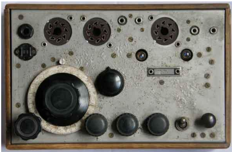
Sl. 1.: Originalna verzija špijunskog radiouređaja Paraset Whaddon Mark VII u drvenoj kutiji
