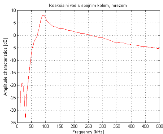
Slika 2. Amplitudna karakteristika spojnog kola korištenog za mjerenje prijenosnih funkcija
