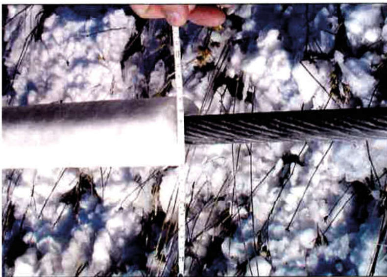
Mjerenje debljine leda na vodičima DV 220 kV Melina–Senj početkom 2003. godine
