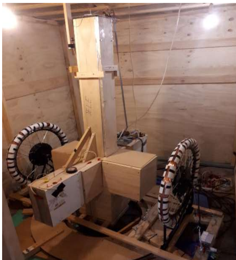
Sl. 8.: Model instrumenta za mjerenje dinamičkog gravitacijskog polja
