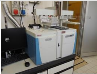
Gas Cromatografo con rivelatore di massa (GC/MS). Strumento da ricerca per antinomia.
