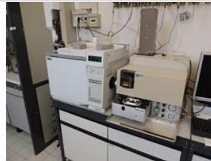
Gas Cromatografo con rivelatore ad emissione atomica (GC/AED). Con esso abbiamo scoperto per primi al mondo l'esistenza del DBDS.
