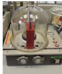
Cella per misure delle proprietà dielettriche dei solidi ( \tan \delta , etc.).
