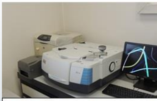
Spettrofotometro infrarosso a trasformata di Fourier (FTIR). Fornisce una specie di impronta digitale di quasi tutte le sostanze chimiche.
