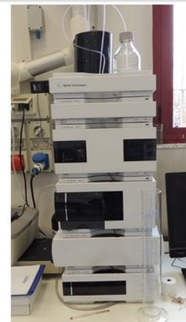
Cromatografo liquido ad alte prestazioni (HPLC), usato per quantificazione additivi nell'olio e prodotti degradati isolante solido.
