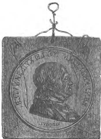
Sl. 165. Patvaranje kolajne galvanoplastikom: kalup.
