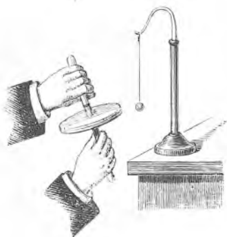
Sl. 26. Neutralizacija elektricitetâ razvijenih trienjem. Prvi pokus.
