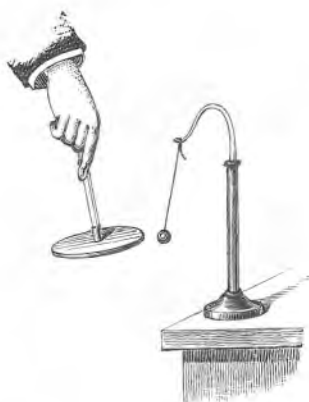
Sl. 27. Neutralizacija elektricitetâ razvijenih trienjem. Drugi pokus.
