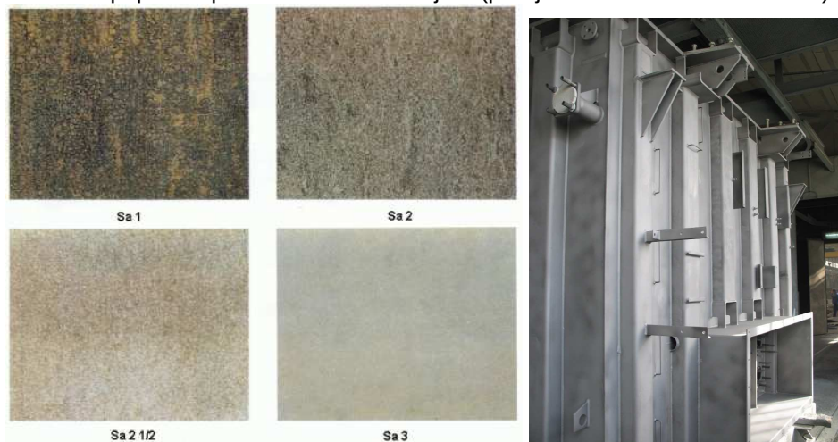
Slika 1. Razredi čistoće metalne površine prema HRN EN ISO 8501, i sačmareni kotao Sa2½
