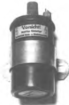
Abb. 8: Hochleistungs-zündspule von Porsche 911 Turbo
