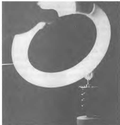
Abb. 73: Ringförmige Leuchtstofflampe erstrahlt im Energiefeld
