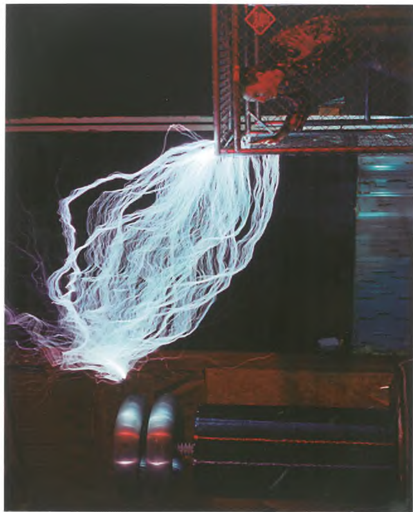
Abb. 41: High Power-Teslapulen betrachtet man besser aus dem Faradayschen Käfig heraus
