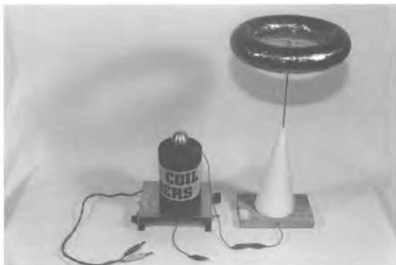
Abb. 69: Tesla-Generator TCL 5 mit angeschlossener Toroid-Antenne
