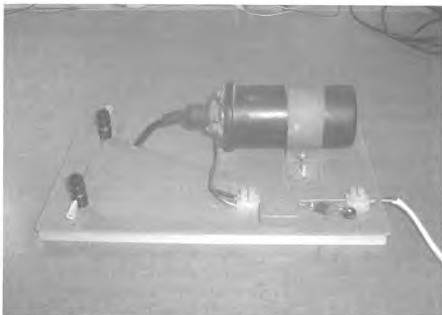
Abb. 31: Versuchsaufbau des Hochspannungsgenerators im Netzbetrieb mit einstellbarer Zündung
