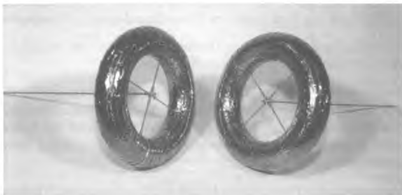
Abb. 9a: Mit Kupferfolie bewickeltes Styropor-Toroid
