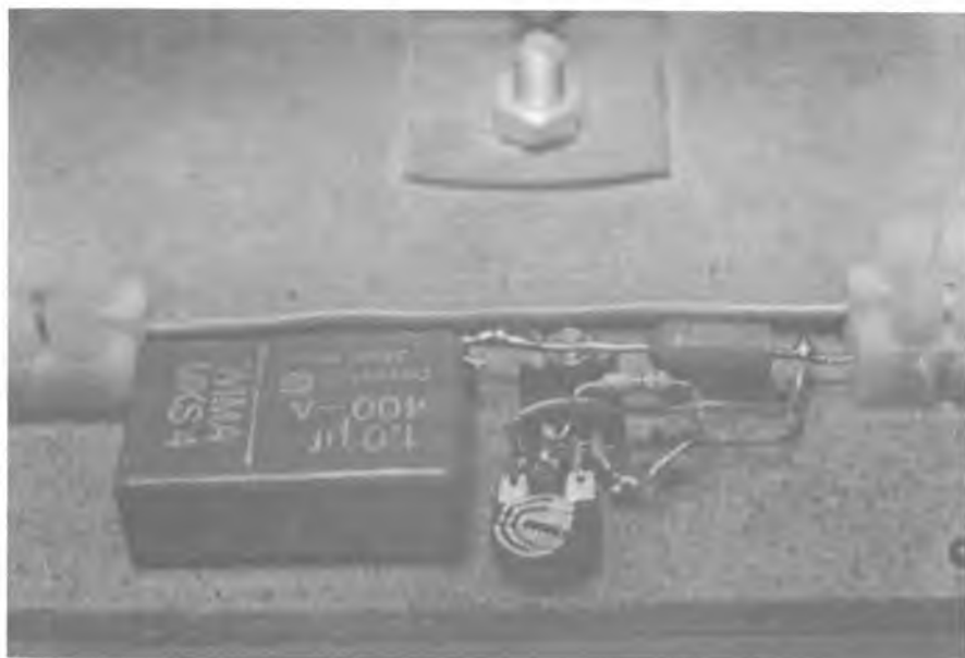
Abb. 32: Es dürfen nur Folienkondensatoren verwendet werden!
