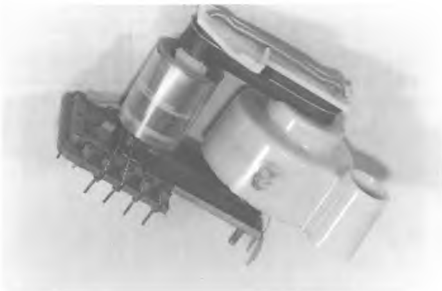
Abb. 57: Zeilentrafo der Firma Oppermann in Steyerberg
