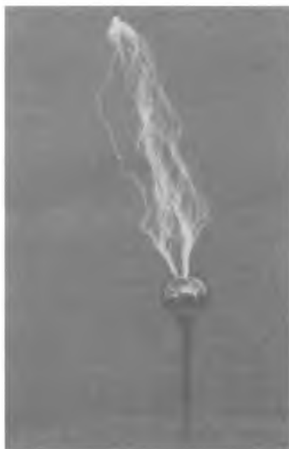
Abb. 87: Funkenentladungen bis zu 18 cm mit Erdungsdraht als Gegenelektrode
