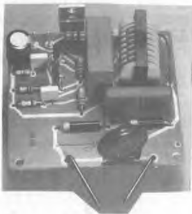
Abb. 5: Fertig aufgebauter Hochspannungsgenerator von EAM
