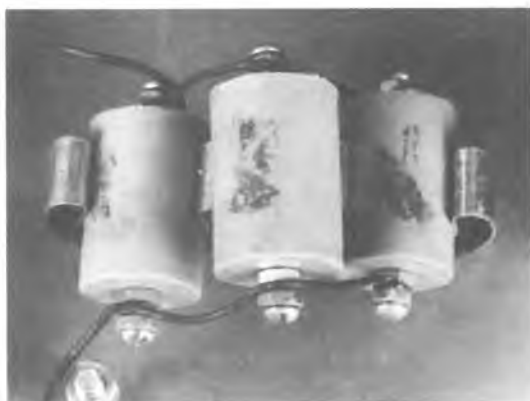
Abb. 65: 3 parallel geschaltete Hochspan- nungskondensatoren mit je 500 pf/20 kV für den Tesla-Generator in Abb. 60
