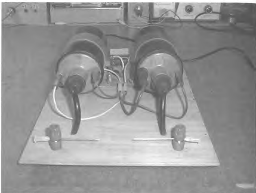
Abb. 29: Versuchsaufbau des Hochspannungsgenerators im Netzbetrieb mit KFZ-Zündspulen im Antiparallelbetrieb
