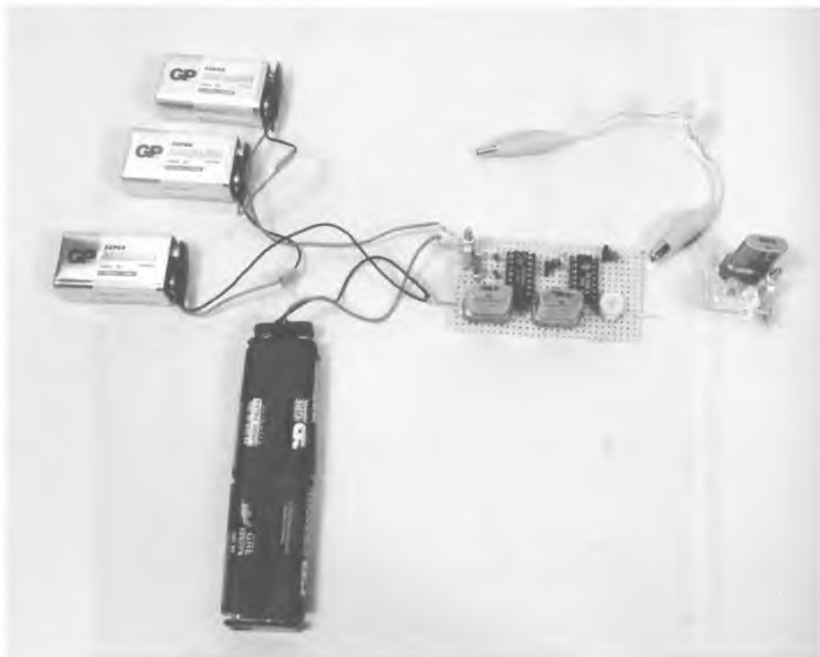
Abb. 75: 13,56 MHz-Sender und -Empfänger
