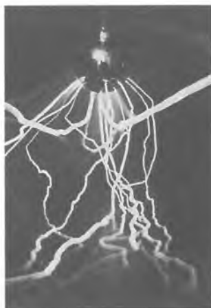
Abb: 11: Funken- überschläge von einer kugelförmigen Elektrode auf eine flächenförmige Elektrode
