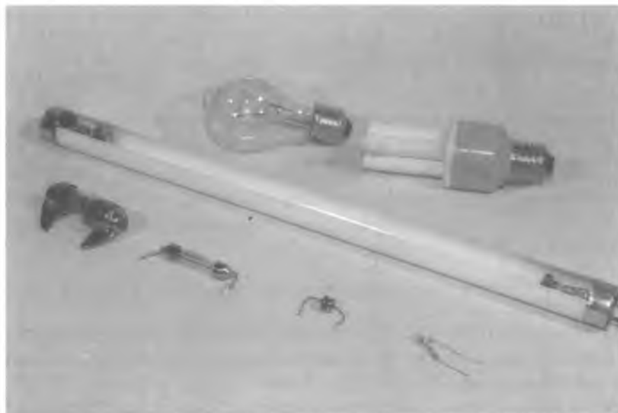
Abb. 63: Glüh-, Glimm- und Leuchtstofflampen zur Strahlungsanzeige
