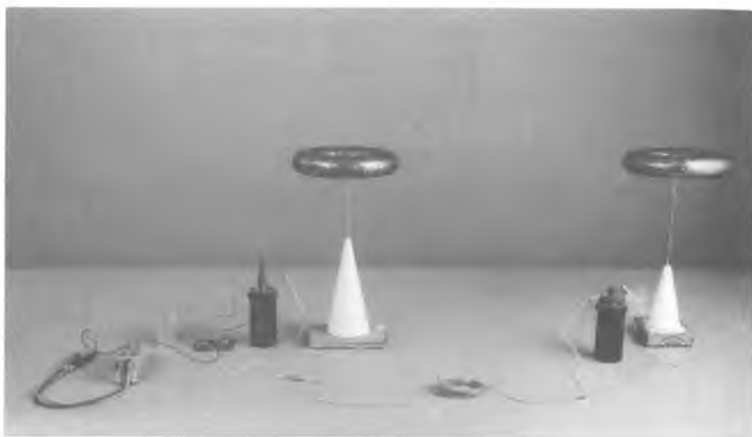
Abb. 81: Versuchsaufbau zur Energieübertragung mit KFZ-Zündspulen (Siehe auch Farbteil)
