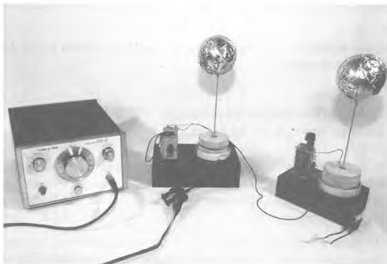
Abb. 29: Sende- und Empfangssystem mit kombinierter Zylinder/Spiralspule bei f_0 = 1 \text{ MHz}
