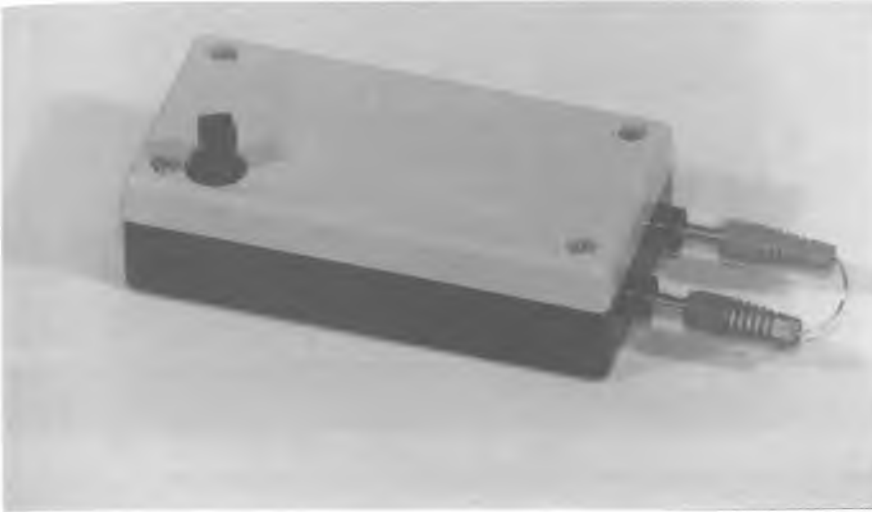
Abb. 8: Piezo-Hochspannungsgenerator mit improvisierter Funkenstrecke
