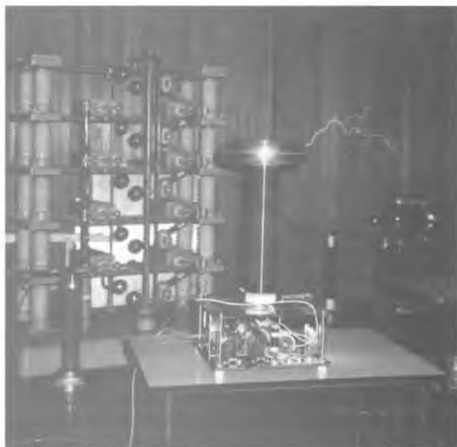
Abb. 13: Mit Blitzlicht fotografiertes, in Betrieb befindlicher Experimental-Teslagenerator (aufgenommen im Hochspannungsraum der Fachhochschule Augsburg)
