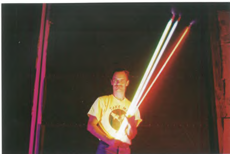
Abb. 38: Neon- bzw. Leuchtstofflampen strahlen ohne Drahtanschluß im Energiefeld
