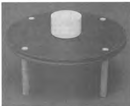
Abb. 55: Tischchen zur räumlichen Trennung von Ansteuerschaltung und Spulenordnung
