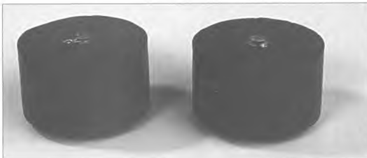
Abb. 63: Hochspannungs-Kondensatoren 3300 pf, 30 kV
