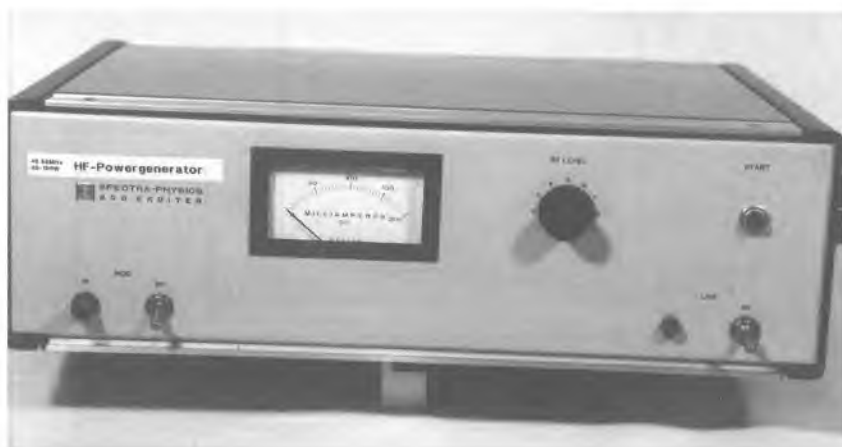
Abb. 40: HF – Powergenerator 40,86 MHz für 40 – 100 Watt Ausgangsleistung
