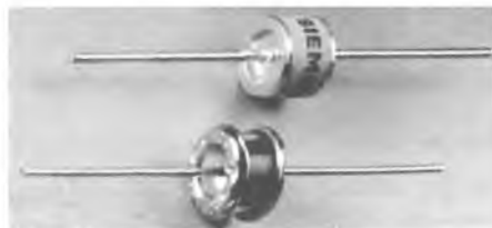
Abb. 16: Überspannungsableiter für 230 V
