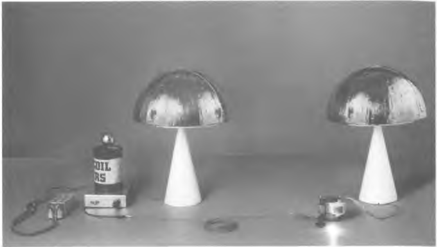
Abb. 71: Höhere Leistungsausbeute mit größeren Antennenflächen (Siehe auch Farbteil)
