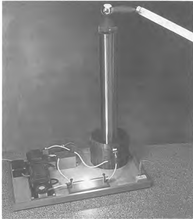
Abb. 72: Tesla-Generator regt Leuchtstofflampe zum Leuchten an
