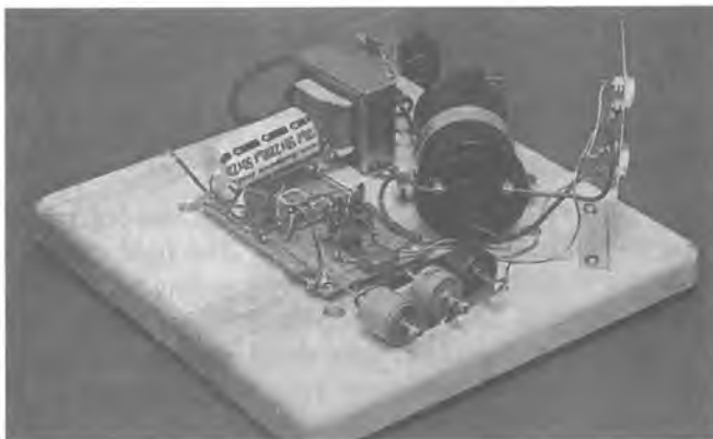
Abb. 53: Die Ansteuerschaltung auf Veroboard und Holzbrettchen
