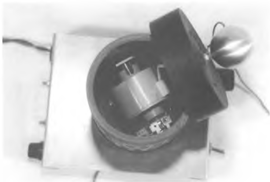
Abb. 59: Zeilentrafo im Kunststoffrohr
