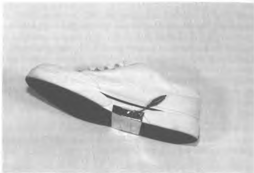
Abb. 49: Turnschuh mit Ionenantenne
