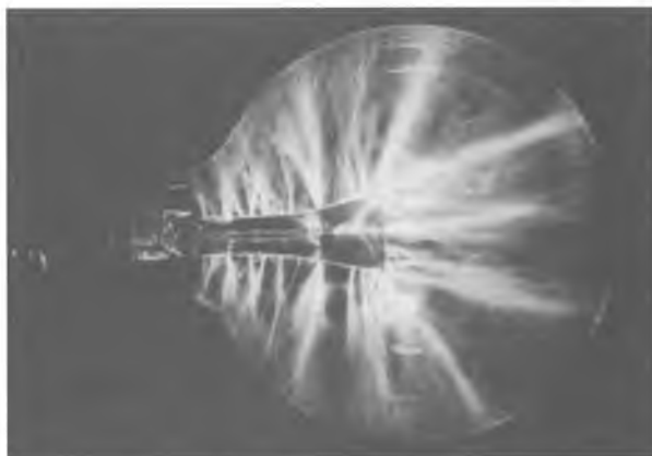
Abb. 79: 220 V-Schaufenster-dekorationslampe als Pseudo-Plasmakugel
