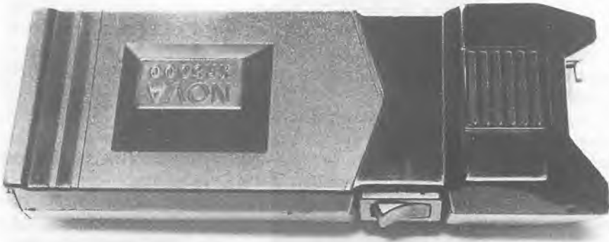
Abb. 9: Elektroschocker als Hochspannungs-Impulsgenerator
