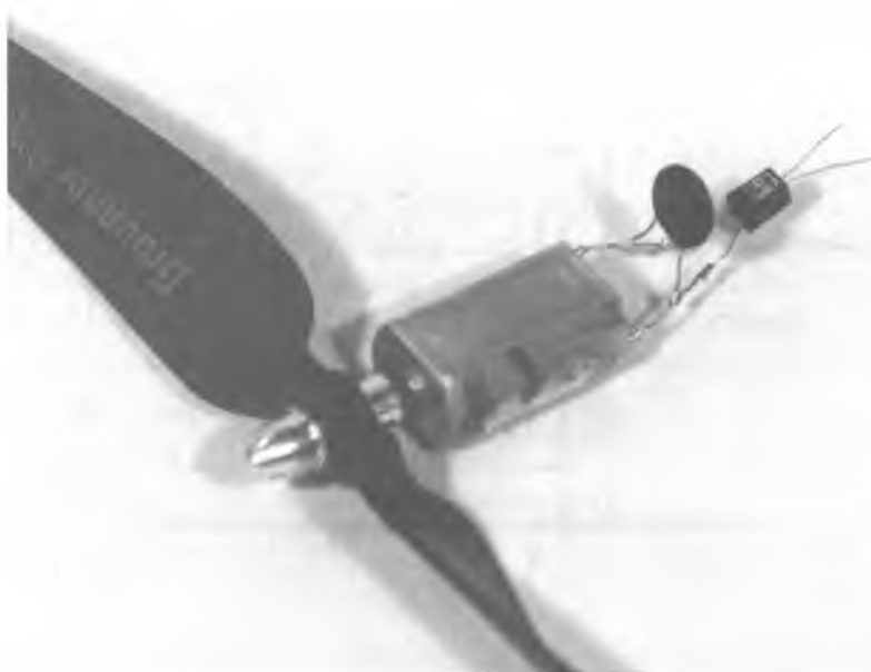
Abb. 59: Hochfrequenzgespeister Spielzeugmotor mit Schottky-Graetzgleichrichter
