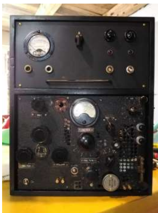
Sl. 30. Prednja ploča ispravljača montirana na kutiju radio stanice BP-5
