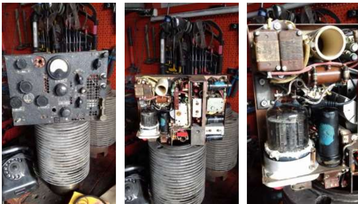
Sl. 3: Slike radio uređaja objavljene na Njuškalu, prednja ploča uređaja (a), stražnja strana uređaja (b) te emisijska i pobudna elektronika (c)
