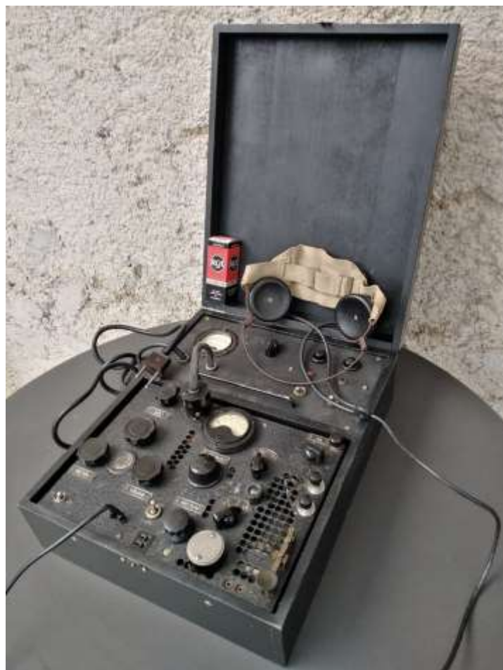
Sl. 35. Uređena, popravljena, kompletirana i ispravna špijunska radio stanica BP-5
