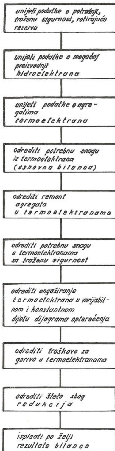
Slika 4.1. Blok-dijagram elektroenergetske bilance
