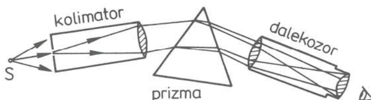
Slika 8.22. Princip rada spektrometra s prizmom
