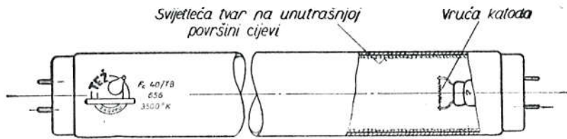
Sl. 196. Fluorescentna sijalica za 220 V je svjetlosna cijev s vrućim elektrodama obložena iznutra tankim slojem svjetleće tvari, koja nevidljivu svjetlost pretvara u vidljivu.
