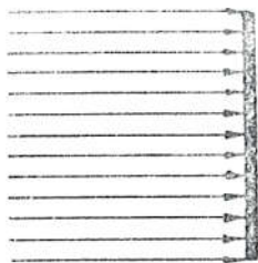
Sl. 207.a. Osvjetljenost je najjača, ako zrake svjetlosti padaju okomito na plohu, koju rasvjetljuju.
