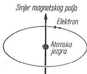
Sl. 127. Elektron, koji kruži oko atomske jezgre, tvori najsitniji magneti.
