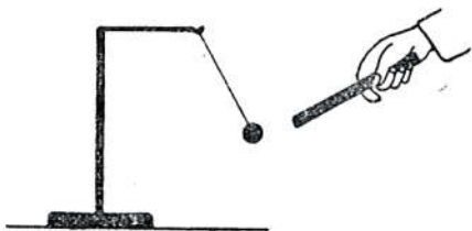
Sl. 52. Štap elektriziran trenjem privlači kuglicu.
