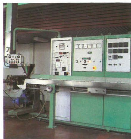
Linija za sekundarnu izolaciju optičkih kabela
