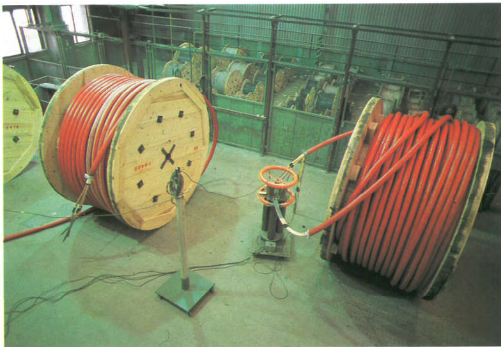
Ispitivanje parcijalnih izboja u izolaciji
