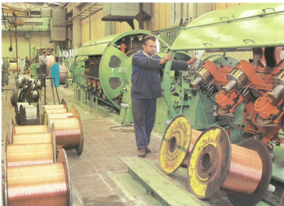
Stroj za izradu sektorske i kompaktirane užadi
