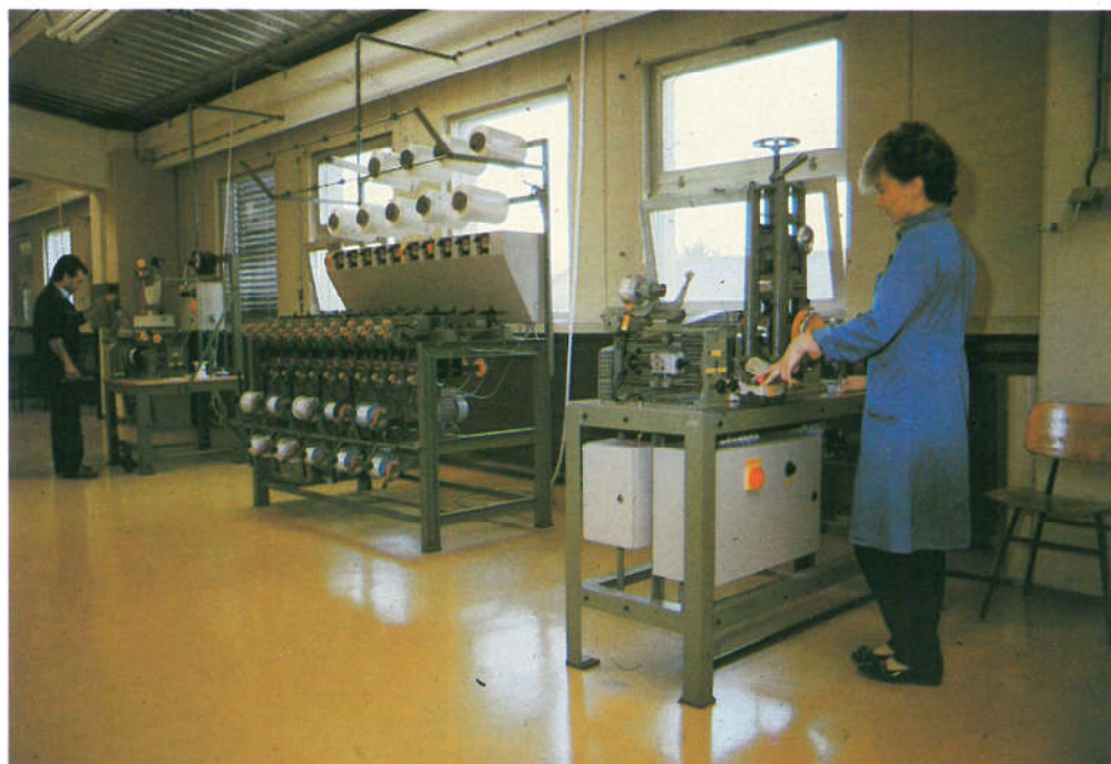
Izrada leonske uzice za spiralne kabele
