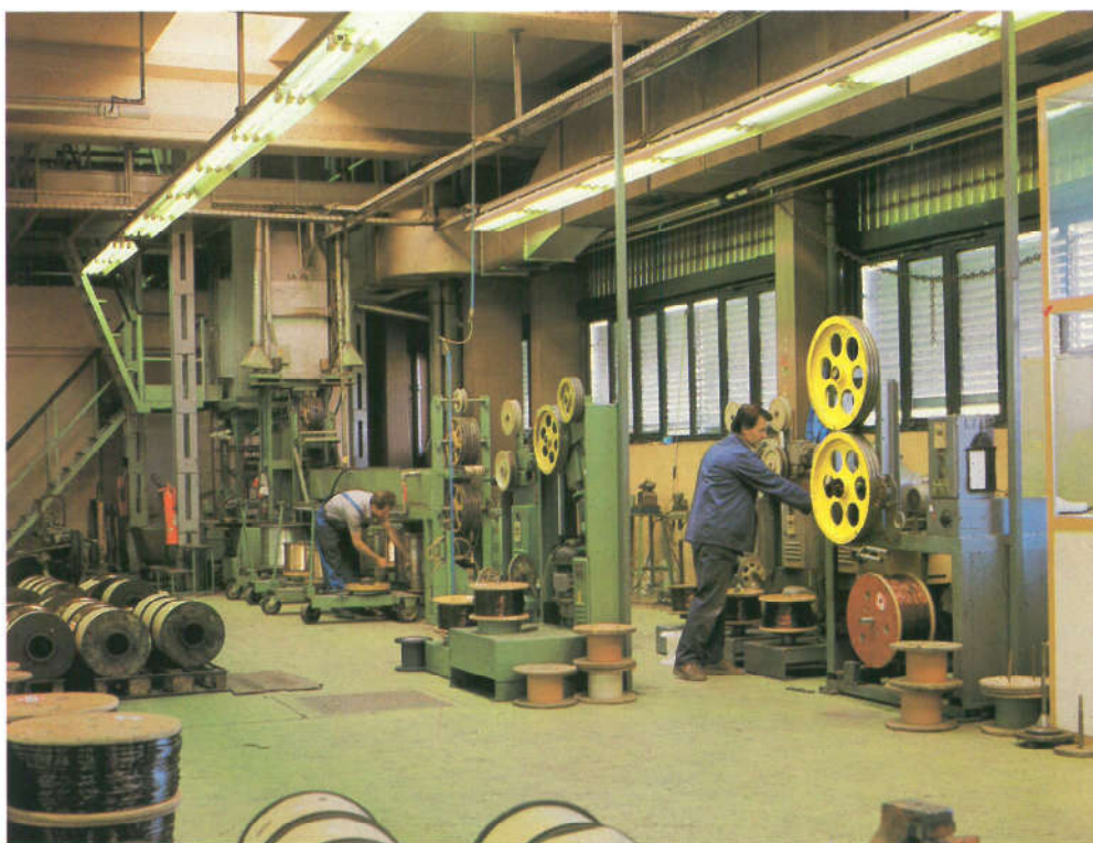
Vertikalni stroj za lakiranje žice
