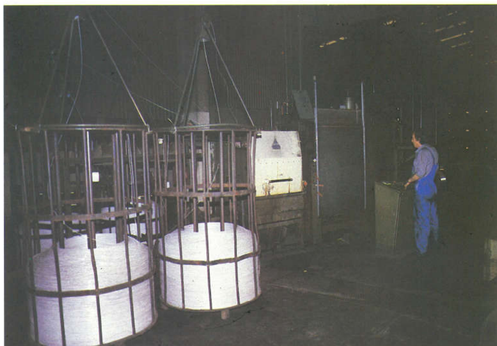
Provlačenje bakrene žice finih dimenzija
