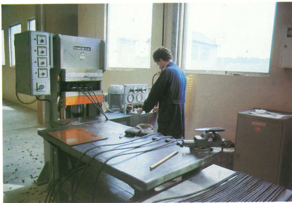
Izrada konektora za vodove i kabele
