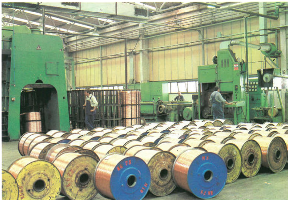
Provlačenje bakrene žice debljih dimenzija
