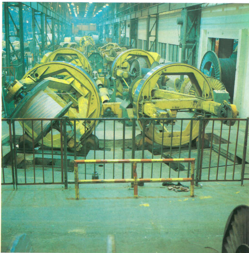
Stroj za použenje energetskih i telekomunikacijskih kabela
