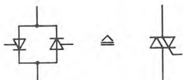
Sl. 8.1. Po funkciji, trijak odgovara dvama antiparalelno spojenim tiristorima
