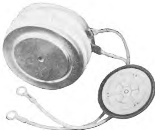
Sl. 6.24. Raspodijeljeni geit omogućuje iniciranje vođenja tiristora foto vo kontinuirano po površini katodnog emitera tiristora (WESTINGHOUSE)
