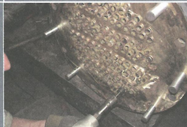
Uvaljivanje cijevi cijevnog snopa
