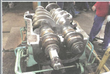
Generalni remont vijčanog kompresora
