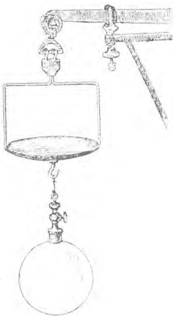
Sl. 178. Vaganje uzduha u staklenu balonu na hidrostatickoj vagi.
