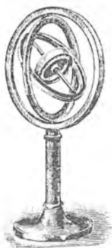
Sl. 187. Bohnenbergerov zvrk. — Održanje smjera osovine kod vrtnje.
