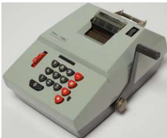
Sl. 9 TRS 108 – mehanička zbrajalica na ručni pogon
