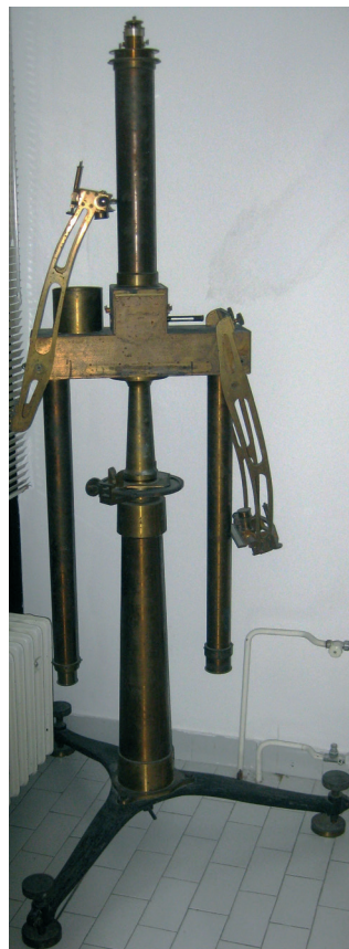
Sl. 1.: Sačuvani Gavazzijev variometar iz 1911. godine.
