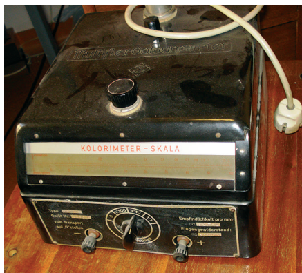
Sl. 4.: Fotoelektrični kolorimetri, početak XX. stoljeća
