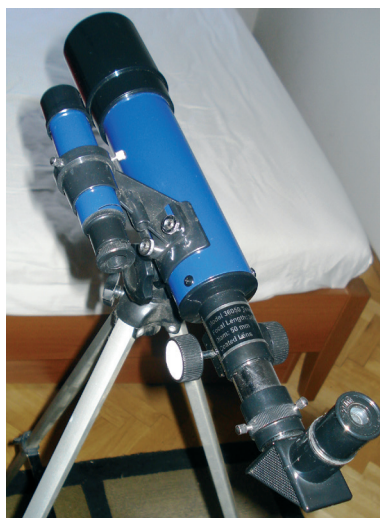
Sl. 9c.: Dječji teleskop refraktor oznake \Phi 50/360\text{mm}
