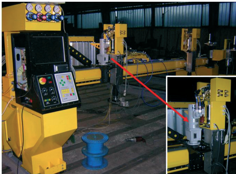
Sl. 14.: Stroj za plinsko rezanje Ivana proizvođača Unicut d. o. o. iz Pule opremljen servoasinkronim strojevima
