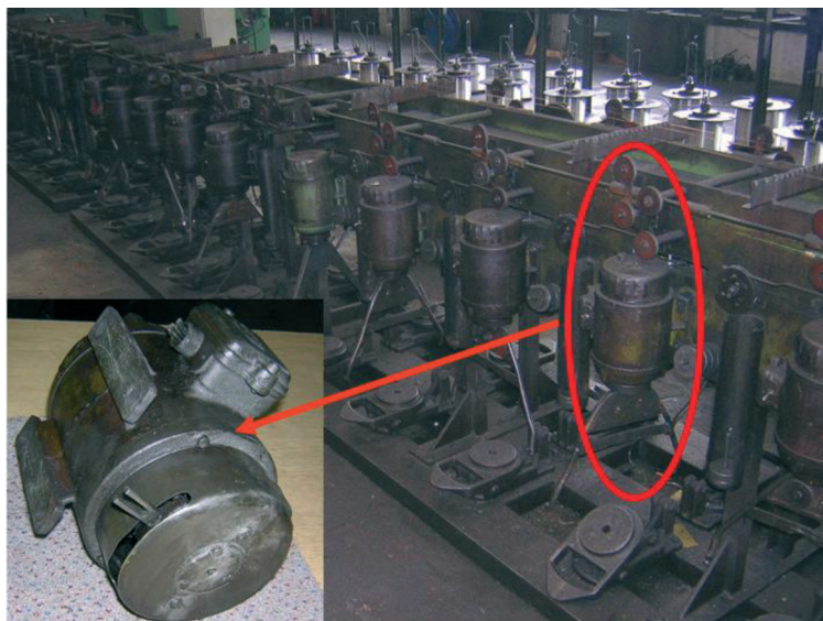
Sl. 9.: Slog odmatača žice u proizvodnji višežičnih vodiča
