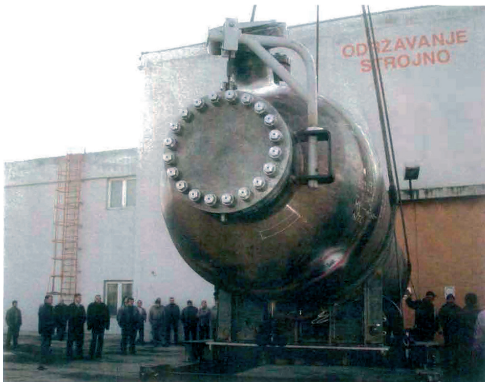
Sl. 8.: Jedan od proizvoda Službe za održavanje TMG-a u brizi za zamjenu dotrajalih dijelova postrojenja (granulator RK 10101 NPK postrojenja)
