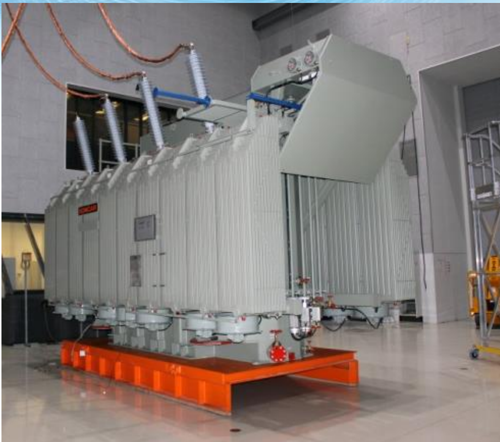
Trofazni uljem izolirani energetski transformator 40 MVA, Njemačka
