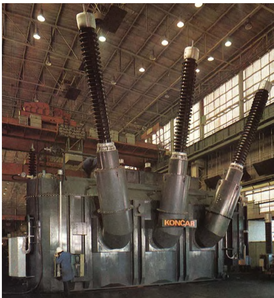
Regulacijski generatorski transformator 400 MVA, 400 kV za NE Krško, 1978.
