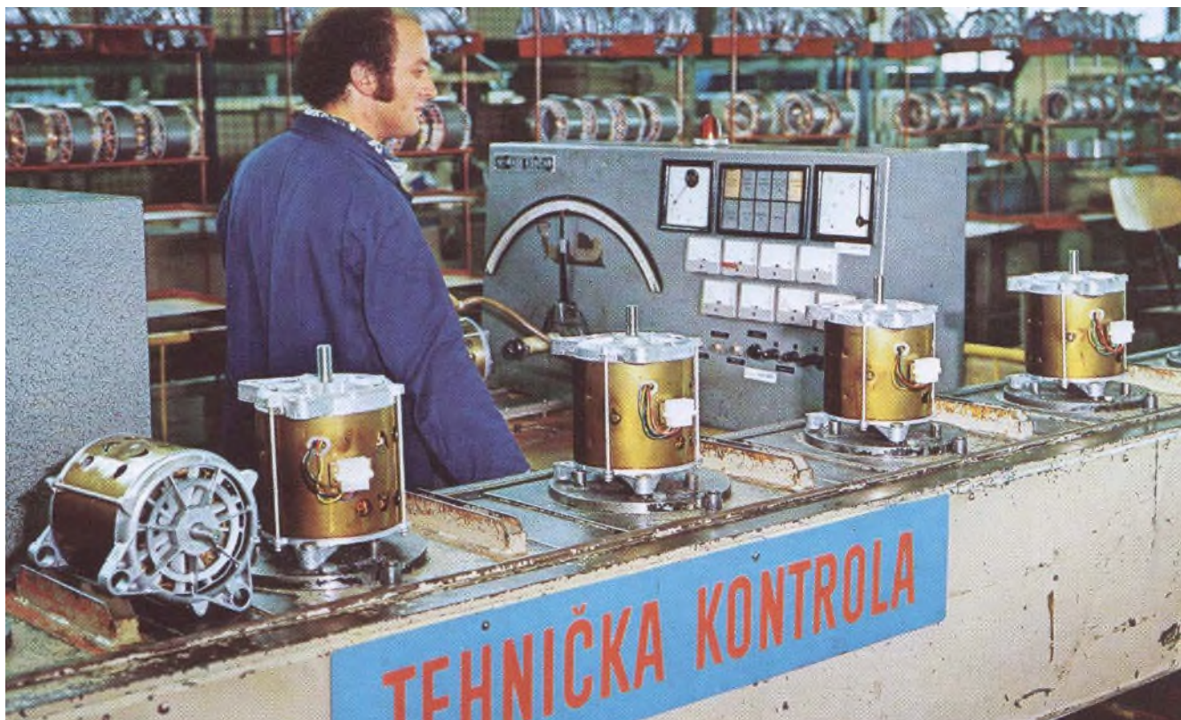
Ispitivanje jednofaznih polno preklopivih motora za perilice rublja, 1975.
