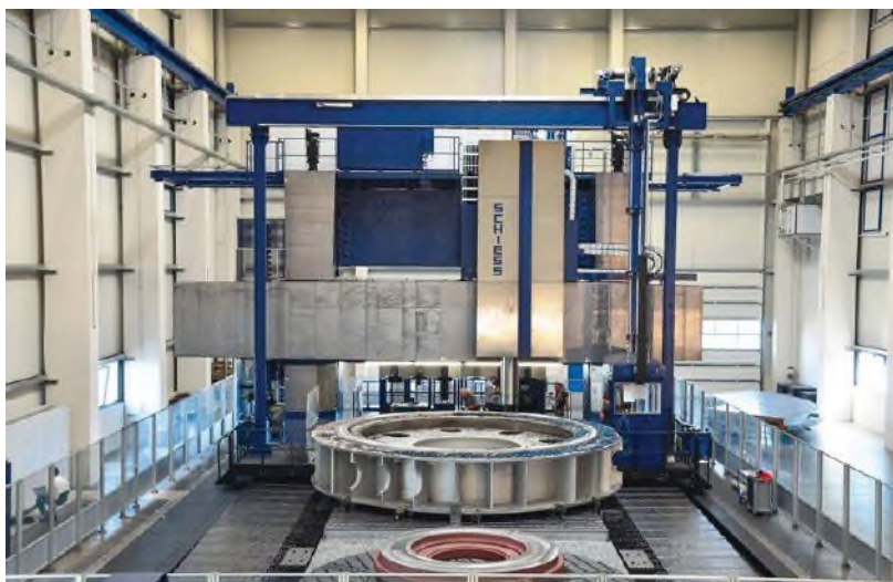
Obradni centar za obradu velikih zavarenih konstrukcija, koji je u procesu montaže u E hali na lokaciji Trešnjevka, 2021.
