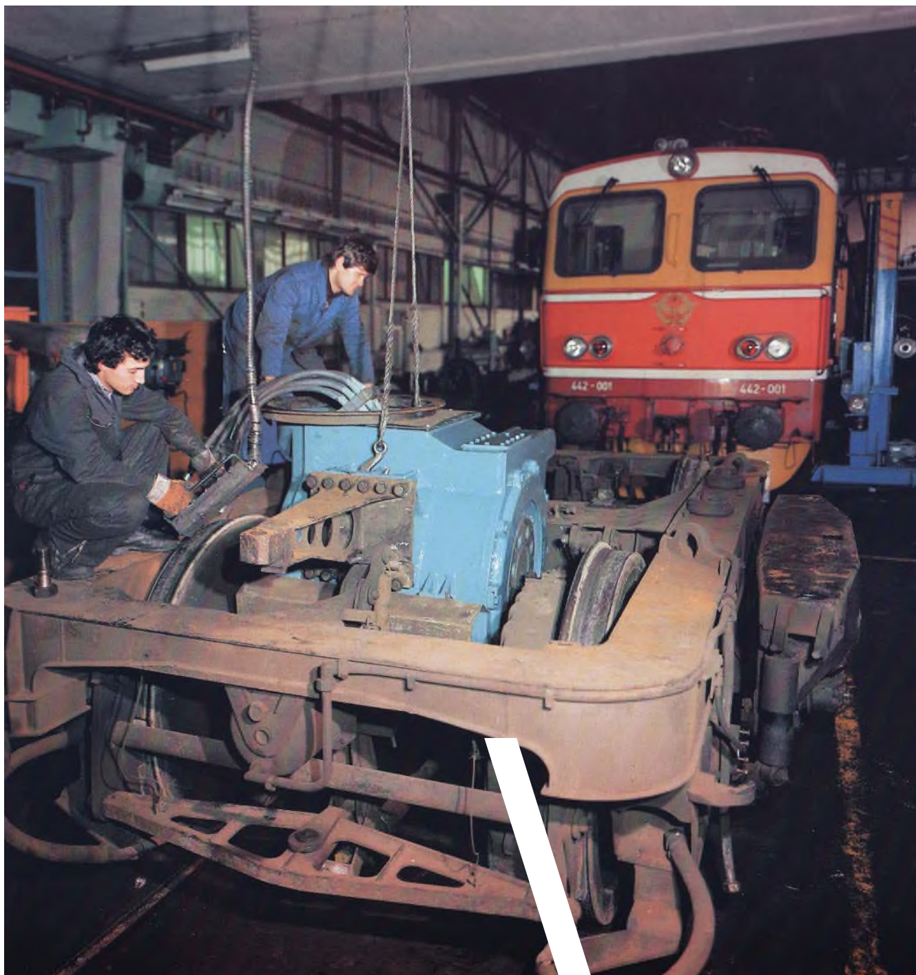
Ugradnja istosmjernog vučnog motora u postolje tiristorske lokomotive, 1985.
