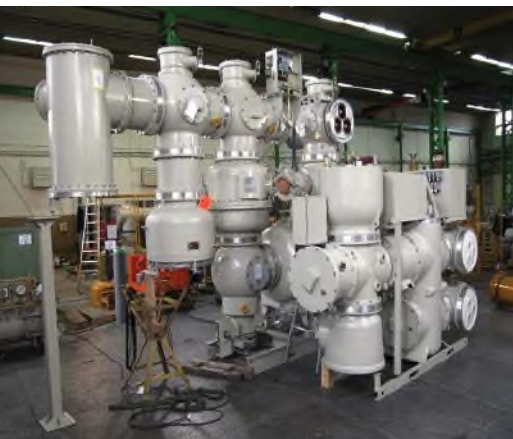
Aluminijem oklopljeno i plinom izolirano postrojenje (GIS) za 145 kV, 2020.
