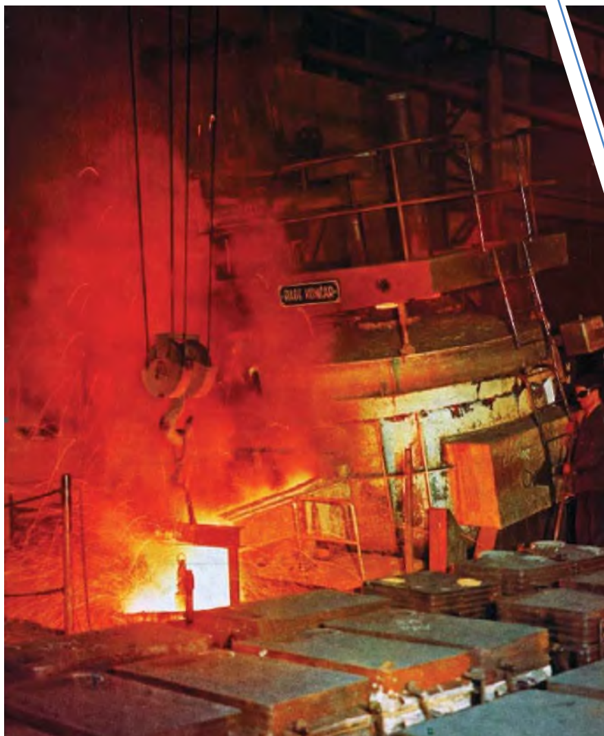
Elektrolučna peć s regulacijom impedancije luka.
