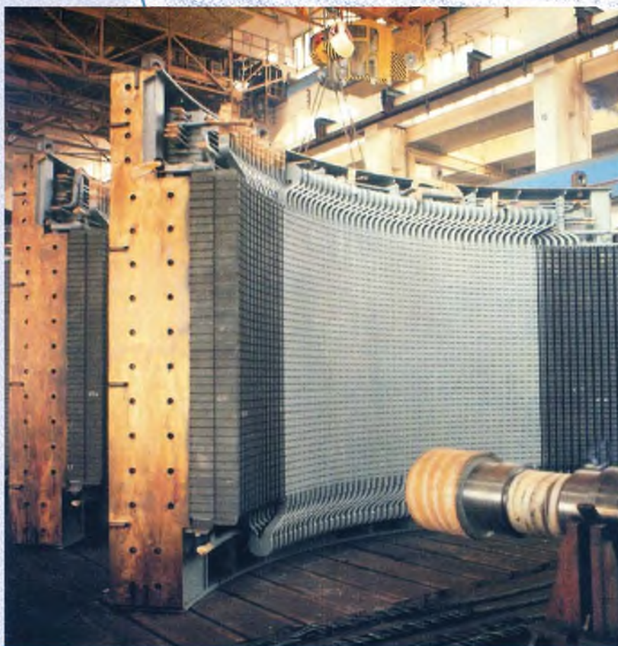
Segmenti generatora HE Shiroro 176,5 MVA Nigerija iz 1983.
