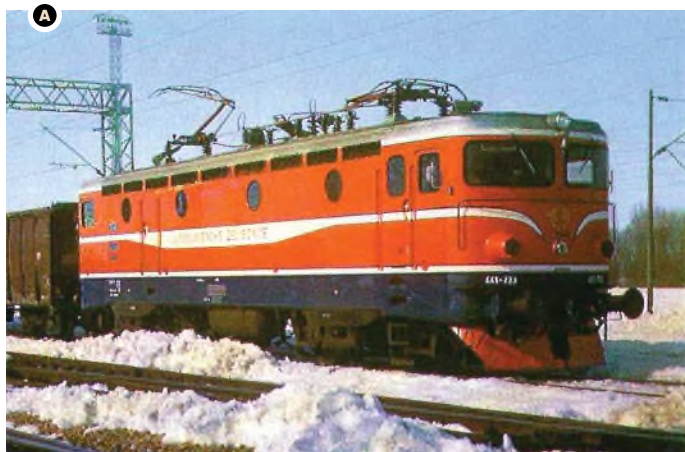
Diodne četveroosovinske lokomotive 25 kV, 50 Hz, 3360 kW, 120 (140) km/h za JŽ proizvedena 1970. (A) i za CFR, Rumunjska, s nizom vlastitih unapređenja za brzinu 120 (160) km/h proizvedena 1972. (B)
