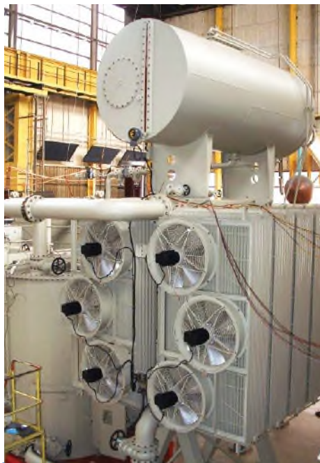
Trofazni autotransformator 500 MVA, 220 / 132 / 33 kV za pustinjske klimatske uvjete za Transformatorsku stanicu Sohar u Omanu, 2005.
