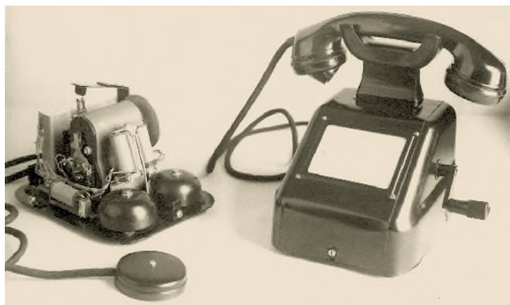
Induktorski telefon kao plod vlastitog poslijeratnog tehničko-tehnološkog razvoja
