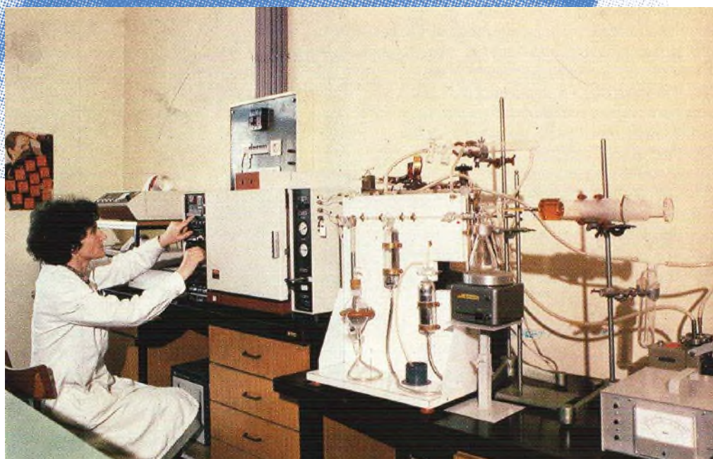
Ispitivanje transformatorskog ulja s pomoću plinskog kromatografa u laboratoriju Instituta 1981.
