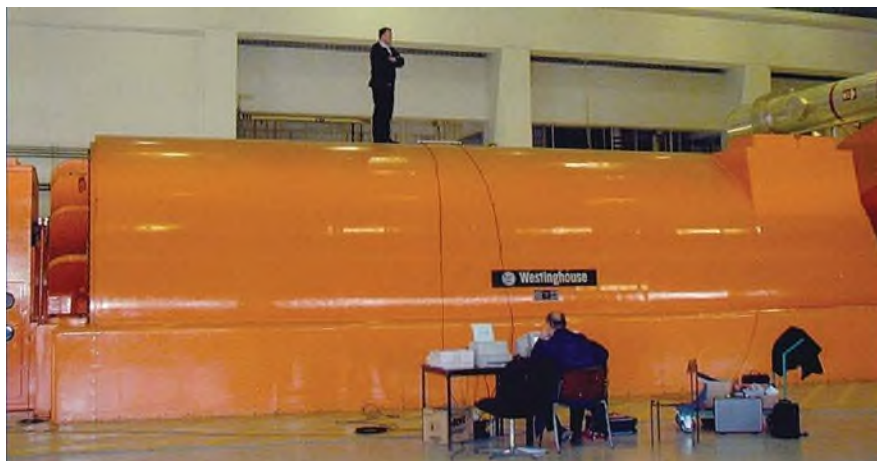
Ispitivanje turbogenerators 700 MW u HE Krško metodom magnetskog monitoringa, 2003.
