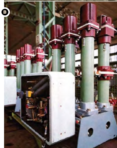
Hidromatski prekidač 30 kV (A) po licencijski Siemens iz 1956. i maloukljni prekidač 12 kV iz vlastitog razvoja u Institutu 1967. (B)
