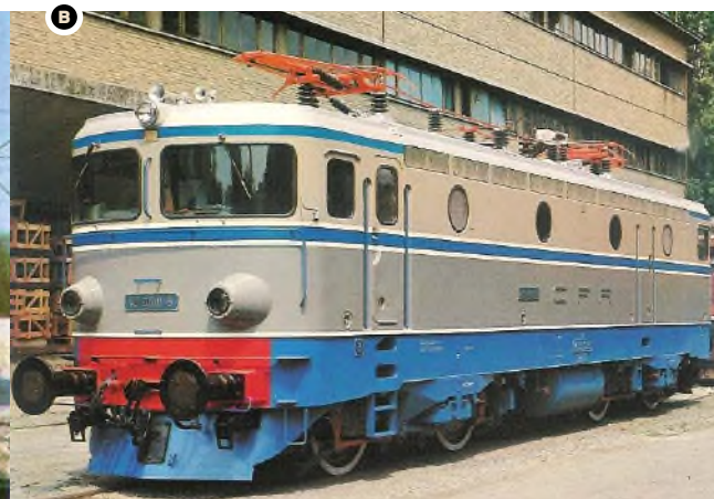
Diodne četveroosovinske lokomotive 25 kV, 50 Hz, 3360 kW, 120 (140) km/h za JŽ proizvedena 1970. (A) i za CFR, Rumunjska, s nizom vlastitih unapređenja za brzinu 120 (160) km/h proizvedena 1972. (B)
