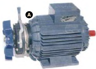
Jednofazni motor standardne izvedbe s pumpom za vodu (A) i jednofazni dvobrzinski motor za perilice rublja (B).
