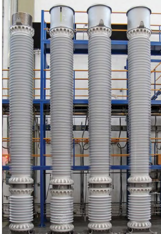
Visokonaponska prigušnica za uzemljenje HVDC postrojenja, 2017.
