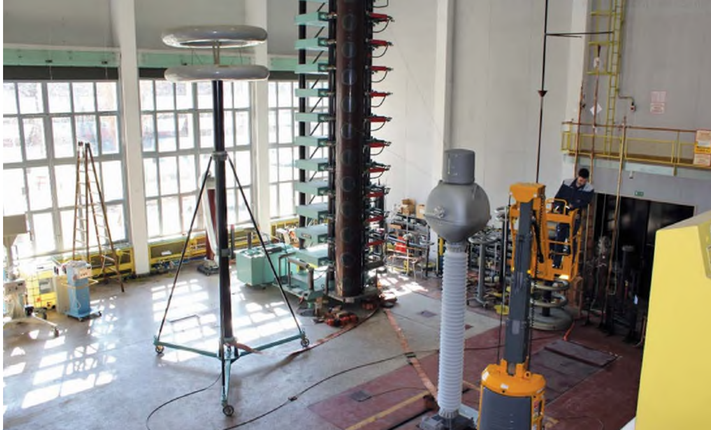
Ispitivanje mjernog transformatora u Visokonaponskom laboratoriju Zavoda za transformatore, 2001.
