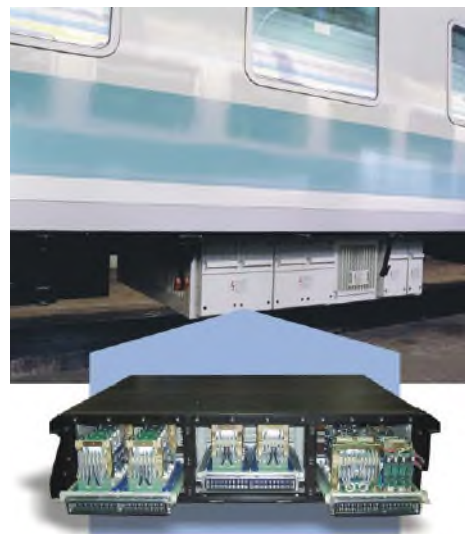
Četverosistemski vagoni pretvarač snage 50 kW razvijen u društvu KONČAR – Institut za elektrotehniku d.d. i proizveden u društvu KONČAR – Elektronika i informatika d.d. za Hrvatske željeznice, 1997.
