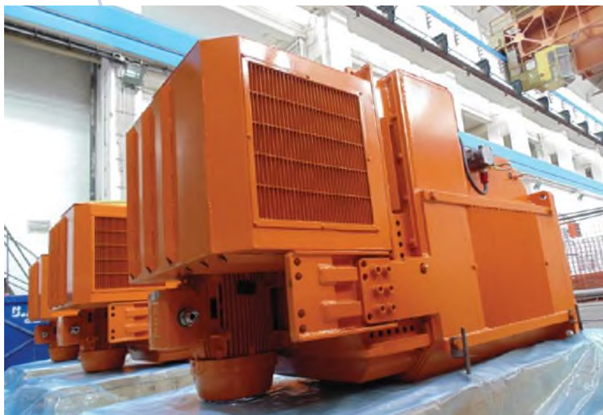
Asinkroni kavezni motor 1000 kW, 520 V, 40 Hz, IP 44, IC 01 s posebnim ventilacijskim sklopom za zaštitu od slane magle za bušače naftne platforme, 2019.
