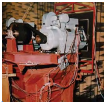
Ispitivanje karakteristika porivne grupe s istosmjernim motorima 2 x 18 kW u Gluhaj komori u Sektoru za rotacione strojeve Elektrotehničkog instituta poduzeća RADE KONČAR, 1983.
