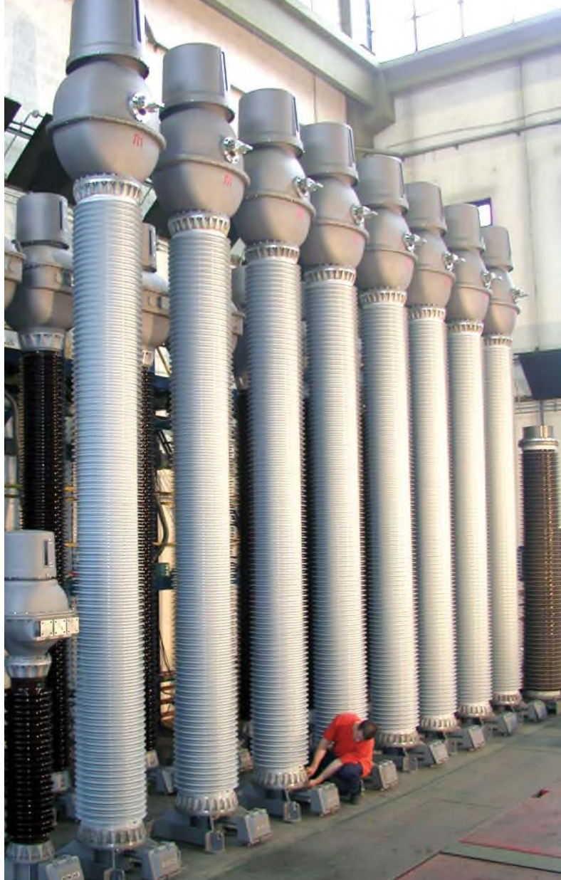
Mjerni strujni transformatori 550 i 750 kV za Rusiju, 2003.
