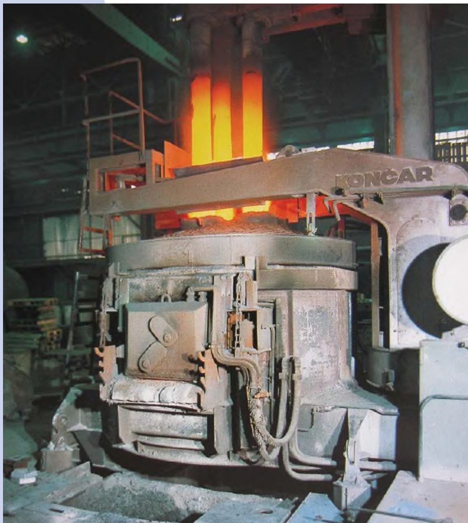
Elektrolučna peč u Željezari Ravne u Sloveniji, puštena u pogon 1981.
