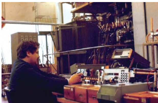
Ispitivanje tzv. rasutog modela tiristorske lokomotive
