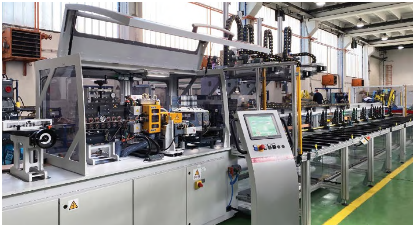
Robot za izradu Roebel prepleta štapova za namote velikih električnih strojeva, pušten u rad 2020.
