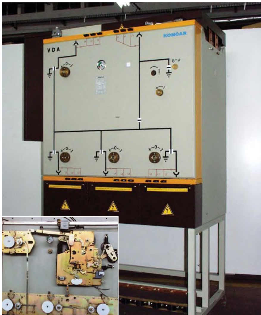
Plinom \text{SF}_6 izolirana vakuumaska distribucijska sklopna aparatura s četiri vodna i jednim transformatorskim poljem, kao i pogonski mehanizam za pet sklopnih aparata u sklopnoj aparaturi
