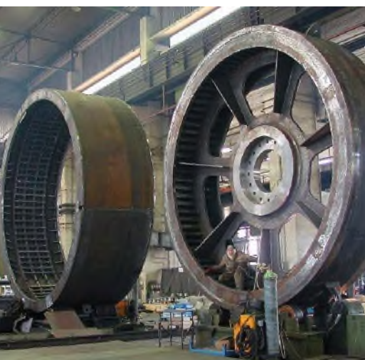
Polni kotač težine 63 tone i promjera 4,3 metara za generator u HE Dubrava, 2002.
