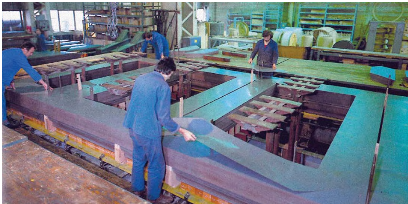
Slaganje peterostupne jezgre transformatora prema inovaciji dr. sc. Z. Valkovića
