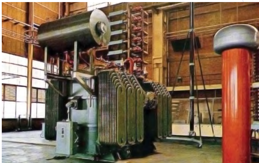
Priprava za ispitivanje udarnim naponom transformatora s modificiranim izvedbom namota, 1970.
