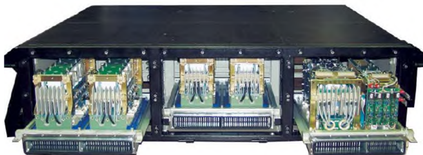
Višesistemski pretvarač 50 kW za putničke vagone (VIS 50-1), 2005.
