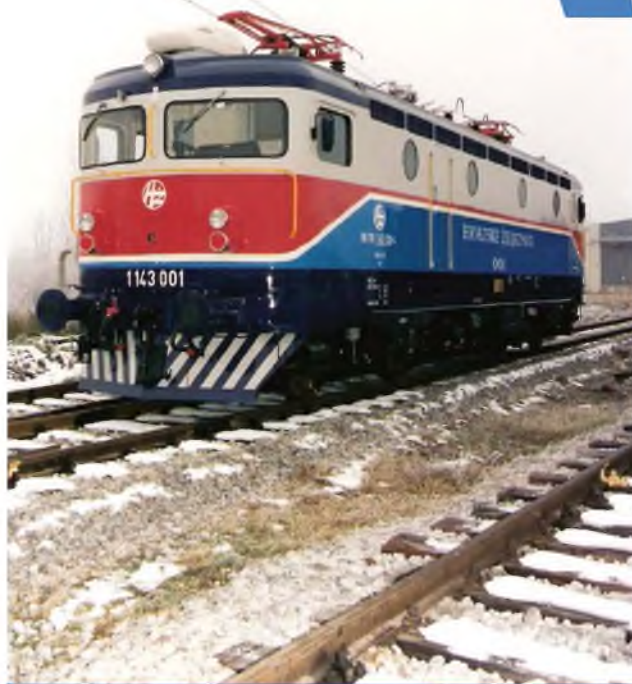
Tiristorizirana električna lokomotiva iz diodne lokomotive za HŽ iz 1996
