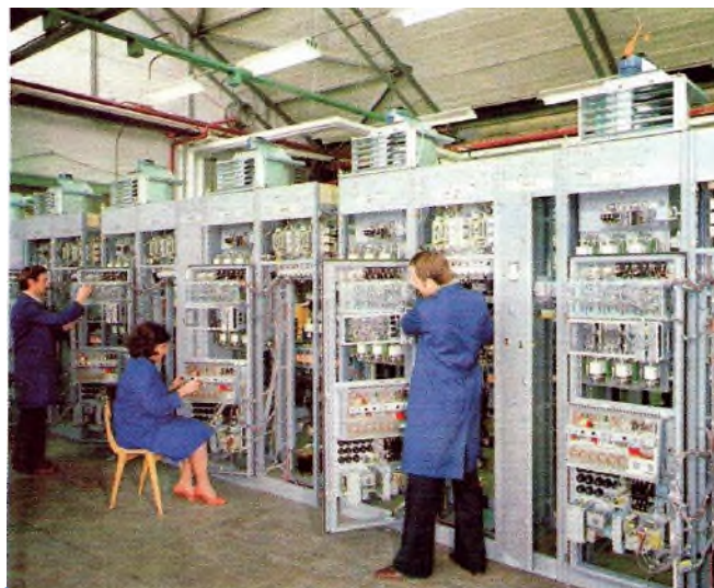
Tiristorski ispravljači za Čeličanu u Tripoliju u Libiji, 1979.
