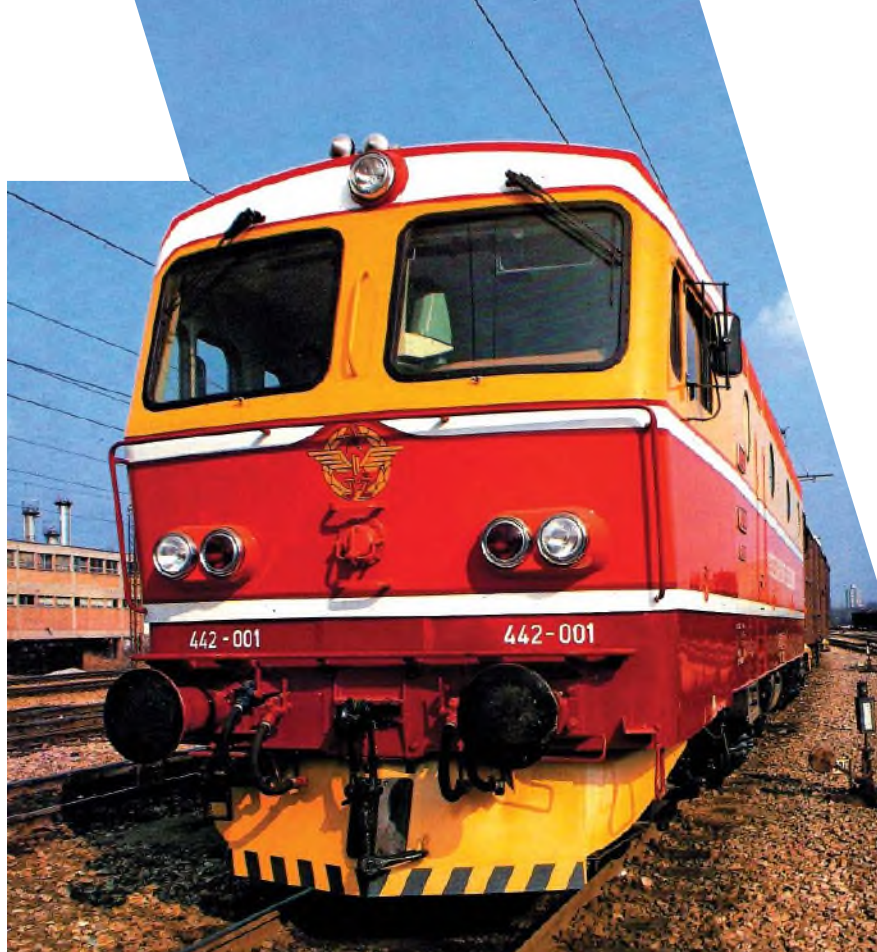
Tiristorska četveroosovinska lokomotiva 25 kV, 50 Hz, 4400 kW, 160 km/h za JŽ, proizvedena 1981. na osnovu vlastitog razvoja
