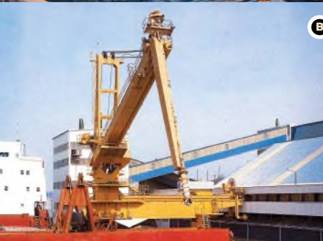
Plovna dizalica nosivosti 100 tona, izgrađena u Kraljevici 1982. (A) i pretovarni toranj za rasute terete u luci Šibenik, pušten u rad 1983. (B)
