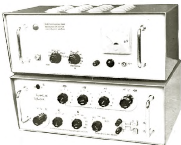
Most za mjerenje kapaciteta i kuta gubitaka i pripadni selektivni elektronički nulindikator, 1971.
