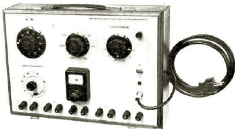
5-kanalni kompenzator za daljinsko mjerenje temperature visoke točnosti, 1970.
