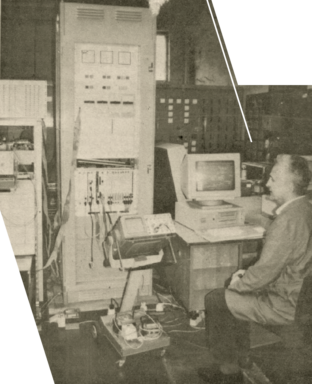
Ispitivanje prototipa digitalnog regulatora napona sinkronog generatora u laboratoriju Zavoda za rotacijske strojeve za HE Fala, 1993. i regulatora za HE Dubrava, 2007.
