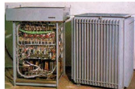
Pretvarač za frekvencijsku regulaciju asinkronih motora s kotlom za ulje, 1980.
