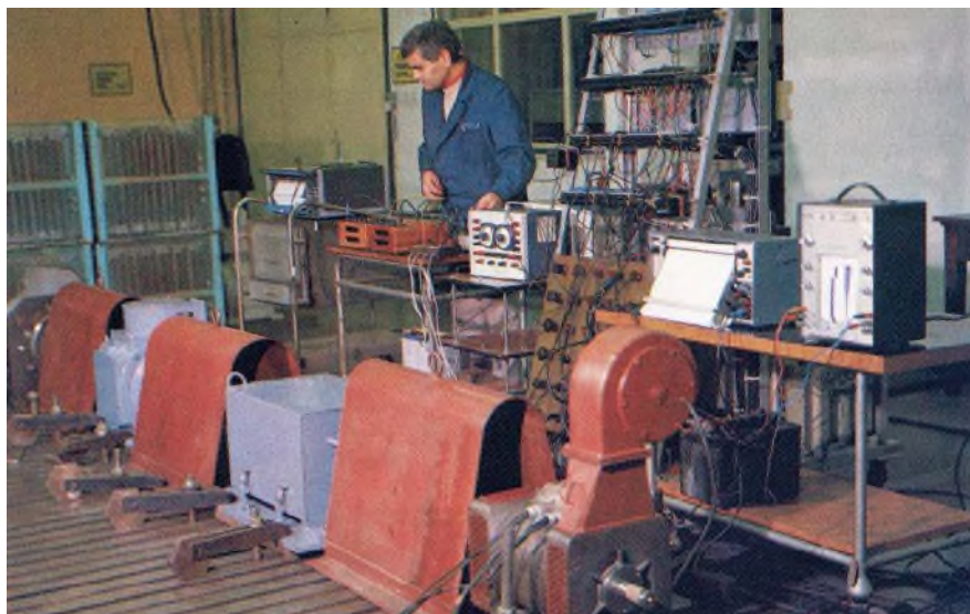
Ispitivanja polnopraklopnog asinkronog motora za dizala u Elektrostrojarskom laboratoriju Elektrotehničkog instituta simulacijom pogona u realnim uvjetima, 1979.
