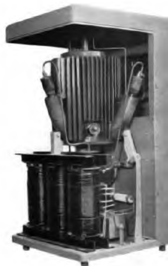
Uređaj za automatsko punjenje akumulatora sa živinim bezpumpnim troanodnim ventilom kao rezultat vlastitog razvoja i proizvodnje
