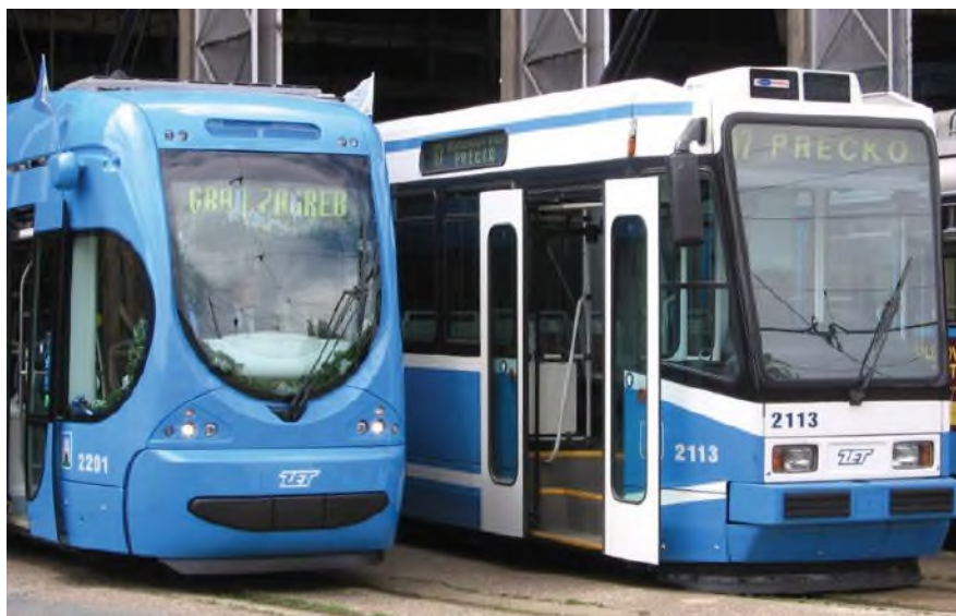
Niskopodni tramvaj serije TMK 2200 iz 2005. i rekonstruirani tramvaj serije TMK 2100 iz 1994.
