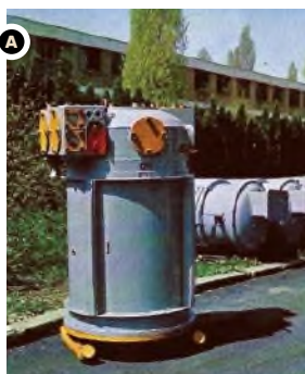
Prvi tlakooklopni motor iz 1958. (A) i tipkalo u tlakooklopnoj izvedbi za upravljanje (B)
