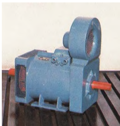
4/16-polni asinkroni motor iz serije 5 AL 132.280 za pogon dizala
