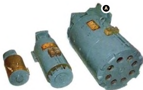
Serijski istosmjerni motori za baterijske napone (A) i jedan iz serije istosmjernih motora snaga od 11 do 310 kW, 440 V s aksijalno prigradenim ventilatorom (B).
