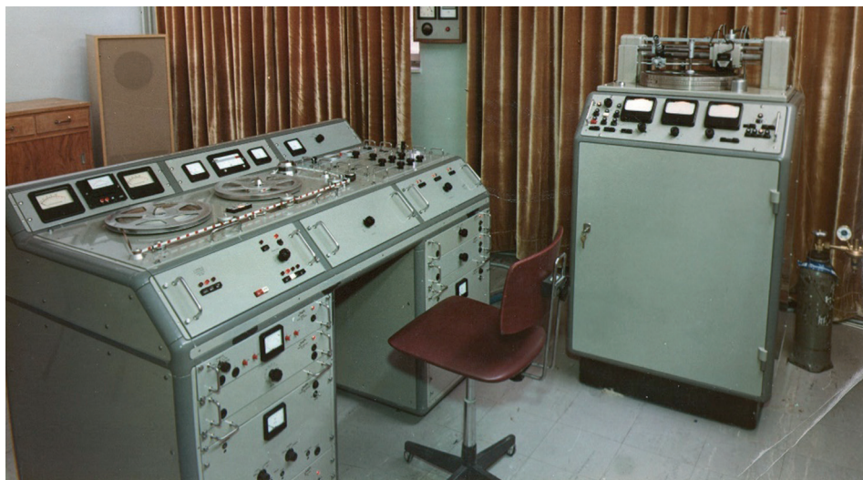
Sl. 29.: Uređaj za snimanje u lak-ploču Ortofon (1963.)
