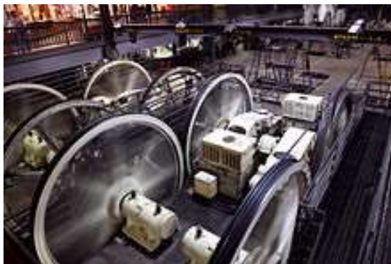
Sl. 22. Centralna parna strojarnica vučnih užeta u Baltimoru (SAD) krajem 19. st. (slika lijevo) i moderna električna strojarnica u San Franciscu (SAD) (slika desno)
