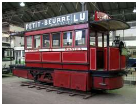
Sl. 18. Tramvaj na komprimirani zraku Parizu, lijevo i Nantesu (Francuska), desno
