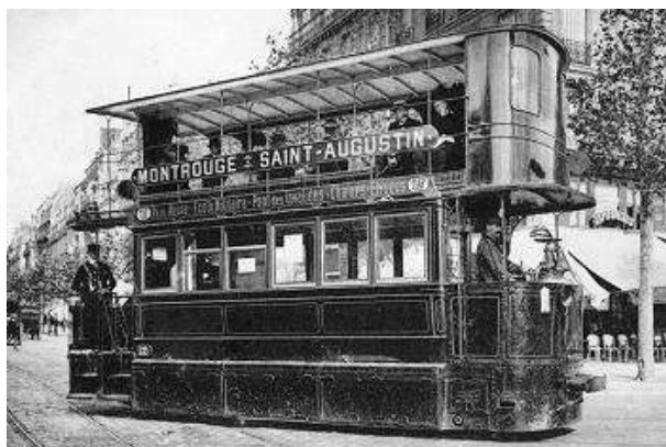
Sl. 18. Tramvaj na komprimirani zraku Parizu, lijevo i Nantesu (Francuska), desno
