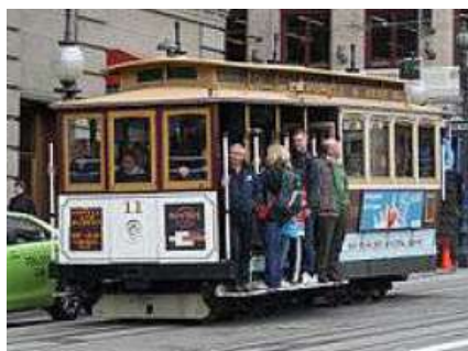
Sl. 23. Tramvaj s pogonom vučnim užetima u San Franciscu (SAD) nekad (1877. god.) i danas
