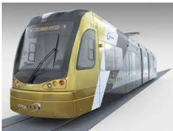
Sl. 28. Moderni niskopodni električni tramvaj s akumulatorima kao dodatnim izvorom napajanja
