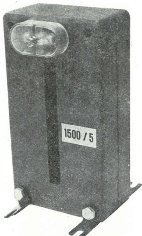
Sl. 5.7. Epoksidni provlačni strujni transformator za nazivne primarne struje od 1 500 do 4 000 A i nazivni napon od 0,6 kV (Fabrika mernih transformatora — Zaječar)
