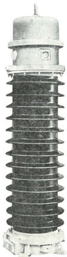
Sl. 5.29. Malouljni naponski transformator s otvorenim jezgrom za nazivni napon od 110/\sqrt{3} kV 100 VA — kl. 0,2 200 VA — kl. 0,5 400 VA — kl. 1 (»R. Končar«)
