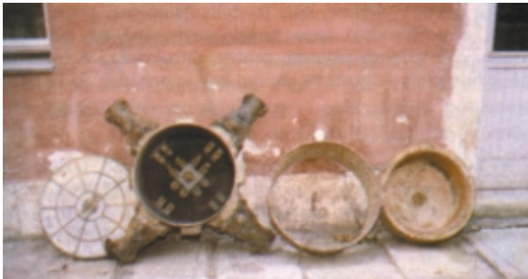
Slika 43. Kabelski razdjelnik iz 1927. g.
