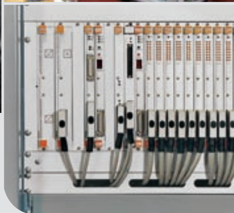
S:5.8. Laboratorijsko ispitivanje prototipa digitalnog regulatora napona sinkronog generatora te tri generacije razvijene tijekom 20 godina: HE Fala (1993.), HE Dubrava (2007.) i TE Rijeka (2008.)
