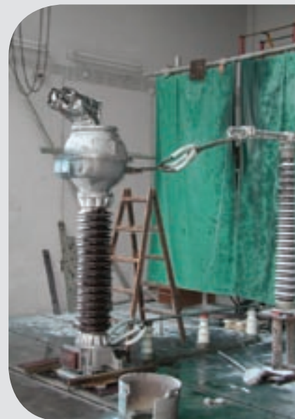
S.5.65. Ispitivanje mjernog transformatora na eksplozivnu otpornost u Laboratoriju za velike snage
