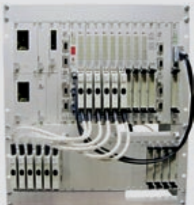
S:5.57. Centralno računalo dizel-elektromotornog vlaka i ispitivanje pretvarača glavnog i pomoćnog pogona koji se smještaju na krov vlaka
