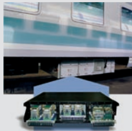
S.5.12. Godine 1998. isporučen je prvi četverosistemski vagonski pretvarač snage 50 kVA razvijen u Institutu, a napravljen u INEM-u
