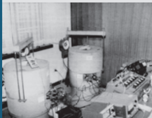
S.5.18. Detalj eksperimentalnog istraživanja određivanja kriterija stupnja ostarjelosti izolacijskog sustava ulje-papir za energetske transformatore iz 1997.
