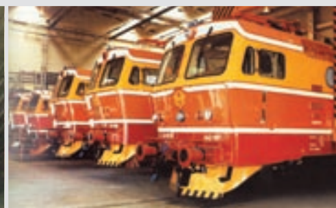
S.4.35. Tiristorska lokomotiva na ispitivanju u stanici ARSENAL u Beču i njena serijska proizvodnja u OOUR-u Električne lokomotive u Jankomiru, Zagreb
