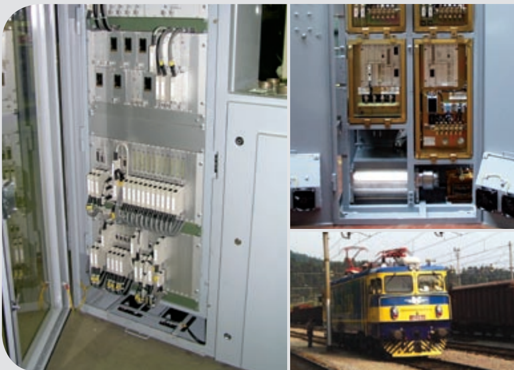
S.5.20. Sustav upravljanja (DIRT) i pretvarač (PJUT). DIRT je razvijen u deset različitih inačica te ugrađen u lokomotive sedam željezničkih tvrtki. Prva inačica primijenjena je u lokomotivama tipa Co'Co' za BDŽ, Bugarska
