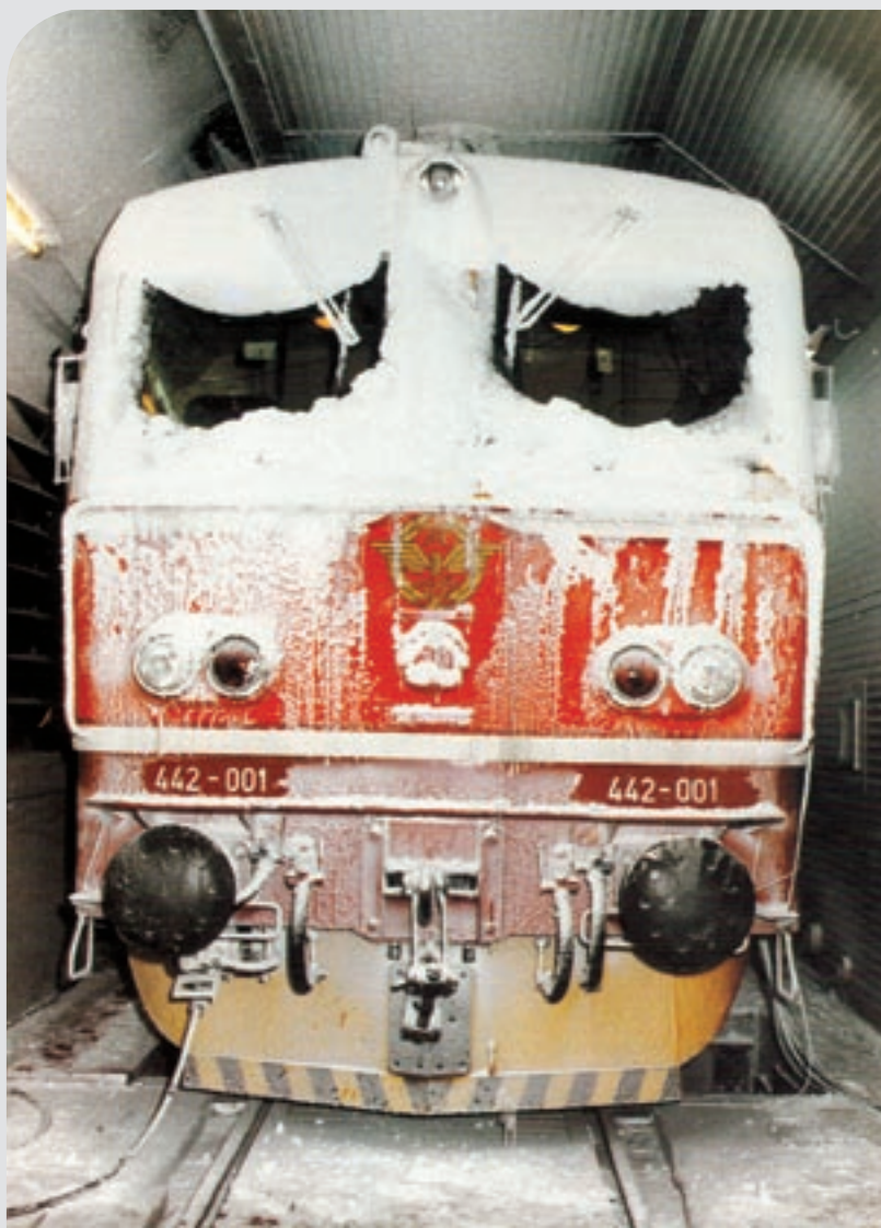
S.4.35. Tiristorska lokomotiva na ispitivanju u stanici ARSENAL u Beču i njena serijska proizvodnja u OOUR-u Električne lokomotive u Jankomiru, Zagreb
