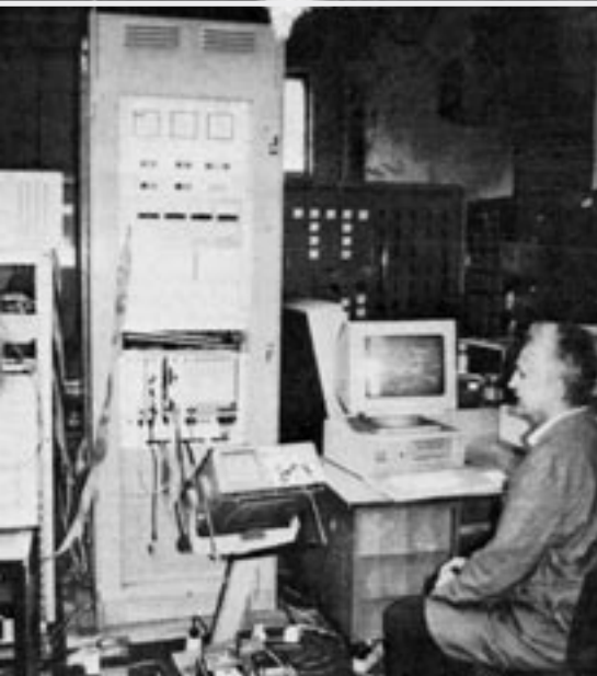
S:5.8. Laboratorijsko ispitivanje prototipa digitalnog regulatora napona sinkronog generatora te tri generacije razvijene tijekom 20 godina: HE Fala (1993.), HE Dubrava (2007.) i TE Rijeka (2008.)
