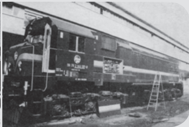
5.15. Prva dizel-električna lokomotiva u koju je ugrađen pretvarač grijanja vlaka PGV pri tipskim ispitivanjima
