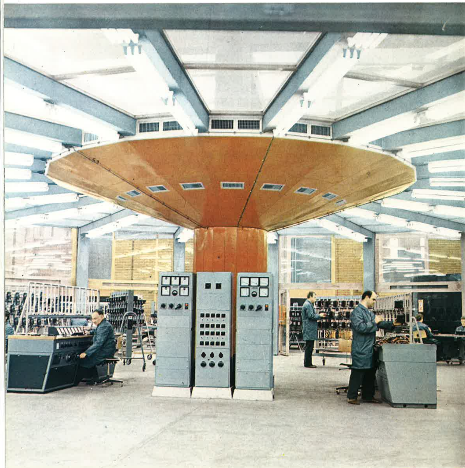
Detalj moderno opremljene baždarnice električnih brojila
