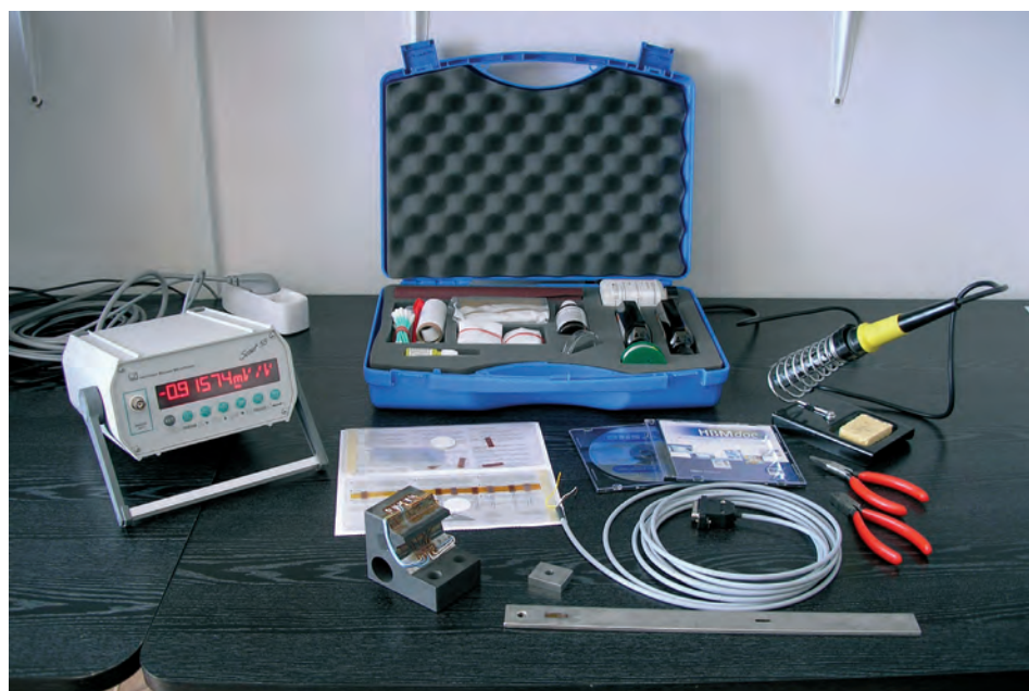
Pribor i oprema za aplikaciju elektrootpornih mjernih traka
