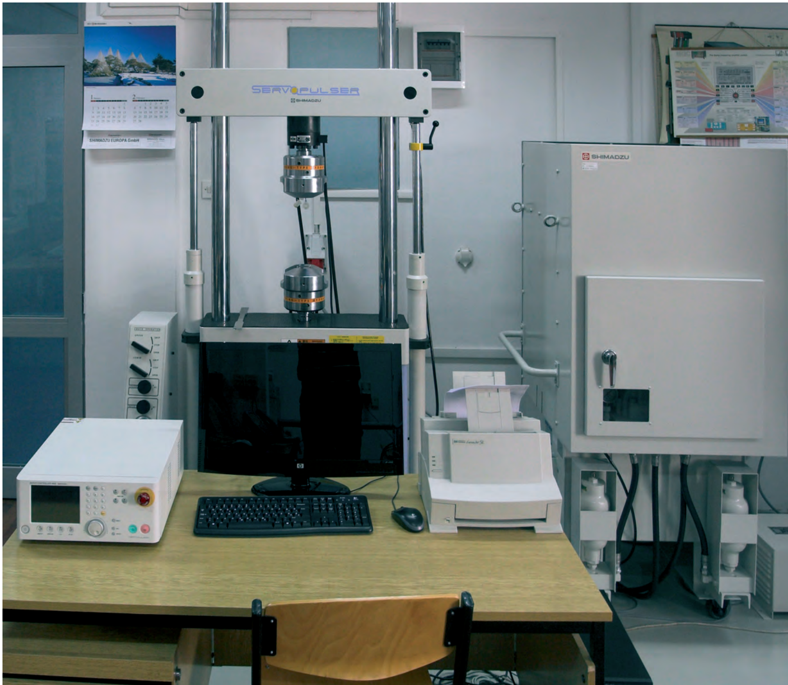
Umaralica (+/- 50 kN: Shimadzu Servo Pulser)
