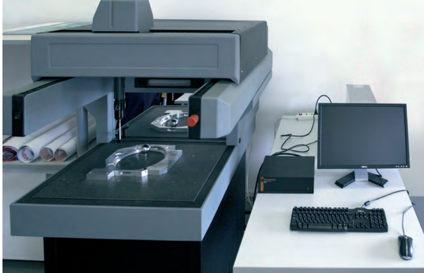
Gore: Univerzalni kalibrator DIGISTANT za senzorska mjerenja Desno: Cyclone – 3D koordinatni uređaj za mjerenje – digitalizaciju
