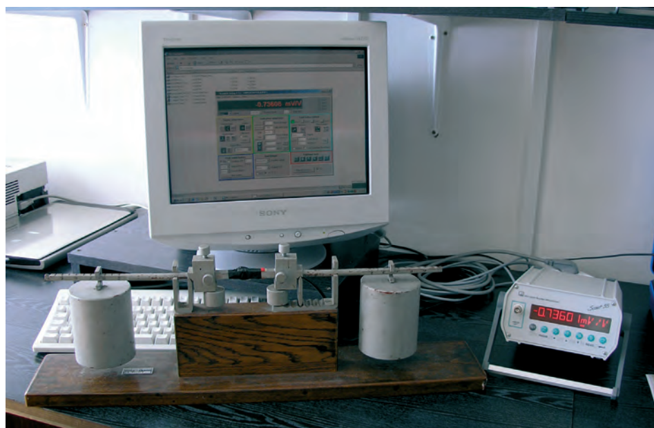
Primjer mjerenja elektrootpornim mjernim trakama
