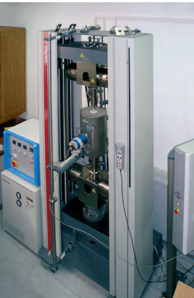
Kidalica 400 kN s pećicom i ekstenzometrom za visoke temperature (Zwick/Roell)
