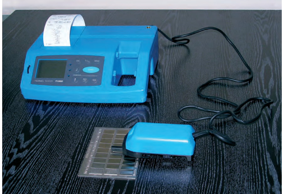
Profilmetar za mjerjenje hrapavosti
