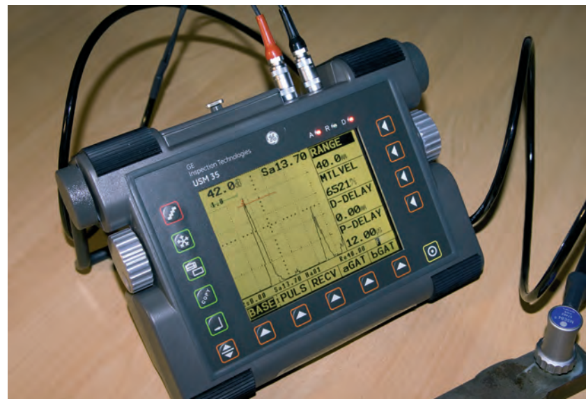
Uređaj za ispitivanje zavarenih spojeva ultrazvukom
