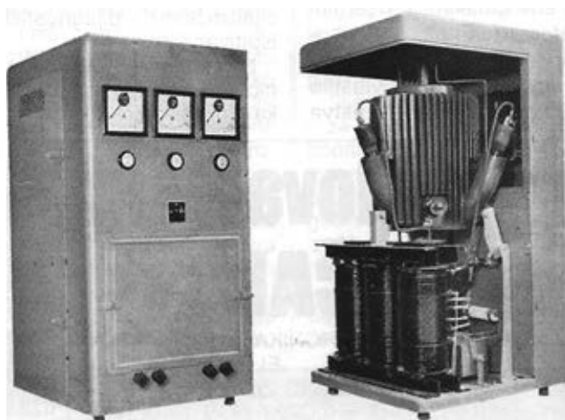
Slika 1.: Uređaj za automatsko punjenje akumulatorskih baterija (110 V, 50 A) sa živinim bespumpnim troanodnim ventilom ( Rade Končar , 1956.). Vide se dvije od tri anodne ruke, provodni izolator pomoćne anode, ispravljački transformator i selenski ispravljač za napajanje uzbuđnog luka. Očito je da je ispravljački spoj trofazni sa srednjom točkom.
