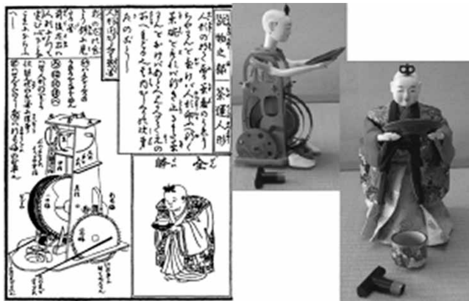
Slika 11.: Chahakobi Ningyo, projekt iz 1796. s izrađenim drvenim modelom [22]
