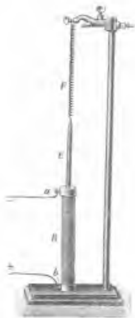
Sl. 25. Princip ampermetra i Voltmetra.
