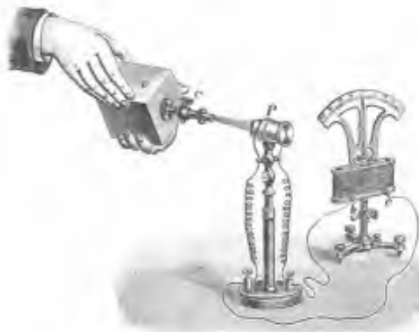
Sl. 15. Osjetljiv termometar.
