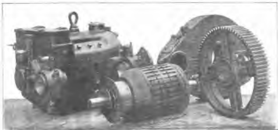
Sl. 71 Tramvajski motor rastavljen.
