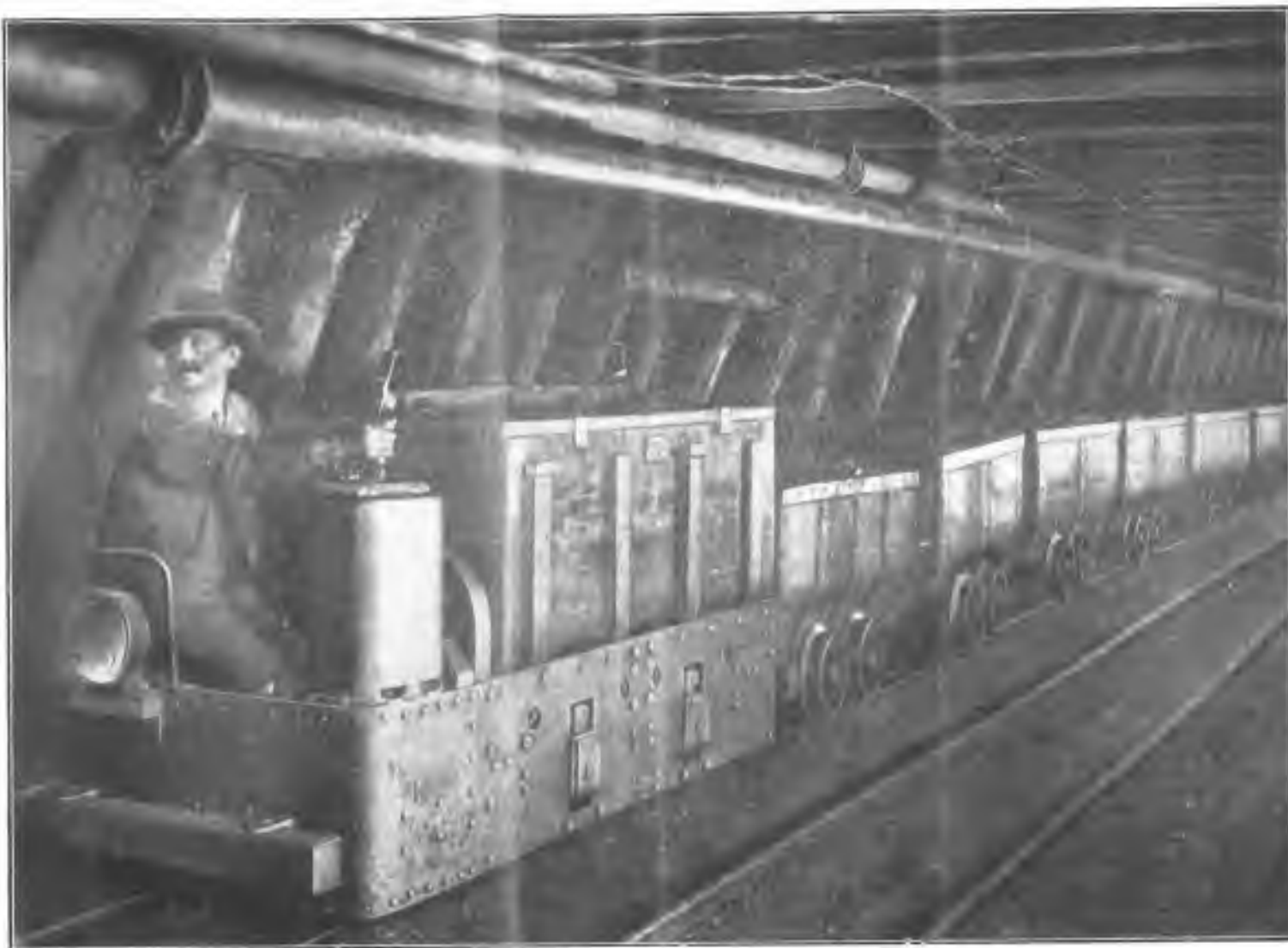
Sl. 95. Električna željeznica akumulatorima u rudniku Grillo u Njemačkoj.
