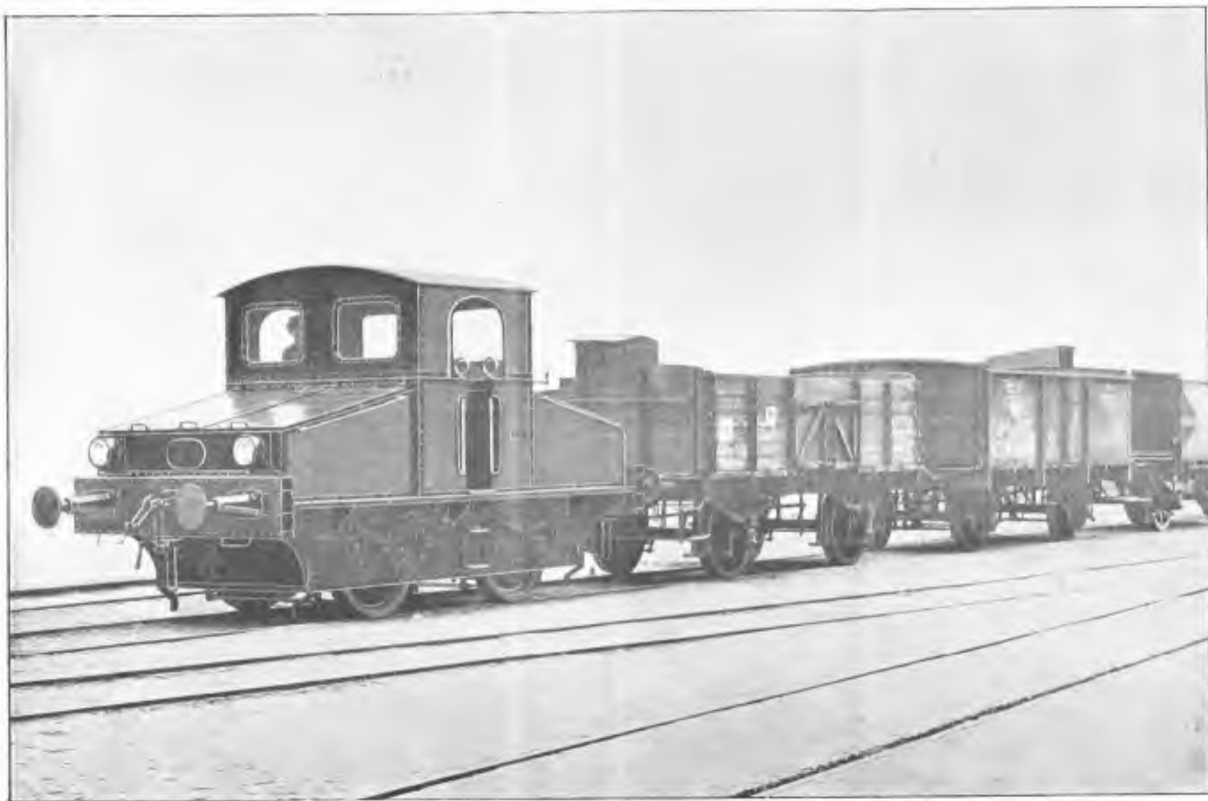
Sl. 90. Elektrický terétní vlak s akumulátorskou lokomotivou.
