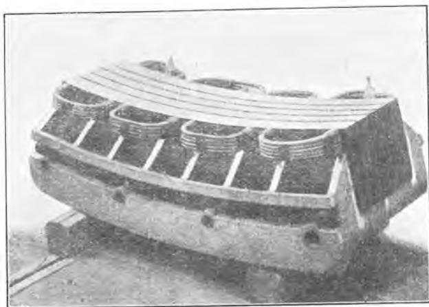
Sl. 22. Dio kotve dinama izmjenične struje (1500 HP).
