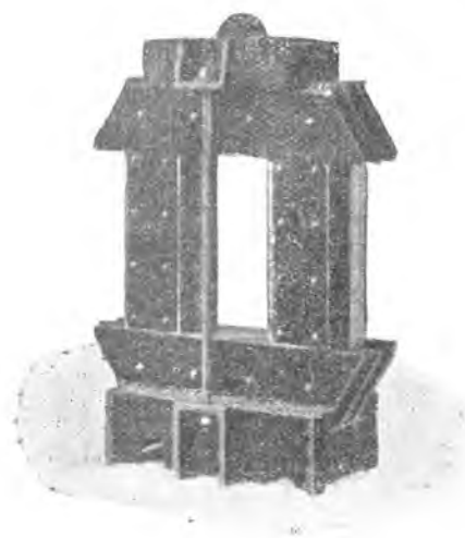
Sl. 38. Oblik izvedena transformatora.
