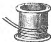
Sl. 10. Svítak žice bifilarno motan.
