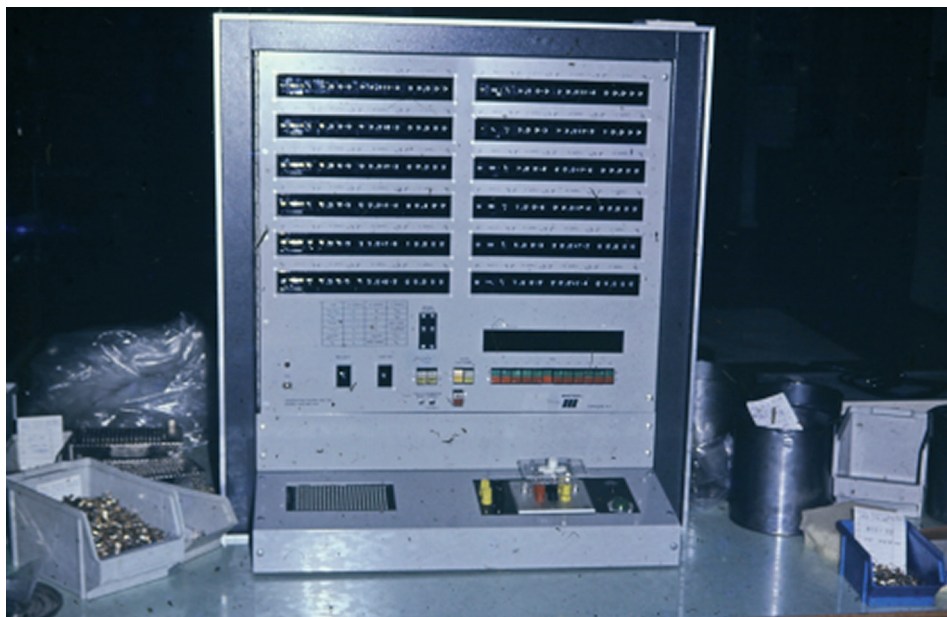
Sl. 27.: Uređaj za električnu klasifikaciju tranzistora
