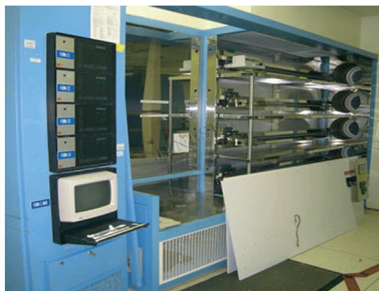
Sl. 5.: Peći za difuziju (starija izvedba peći bila je u TPV-u)
