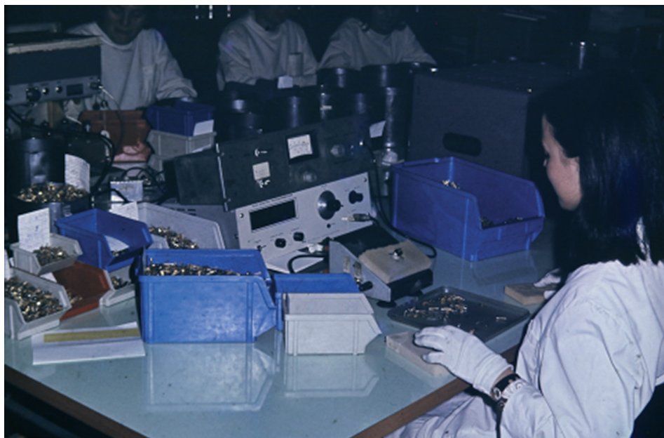
Sl. 28.: Uređaj za mjerenje inverzne struje tranzistora
