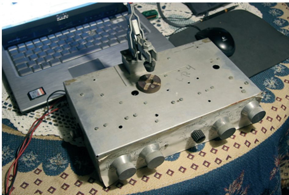
Sl. 37.: Mjerni sklop za tranzistor 150 W, 30 MHz
