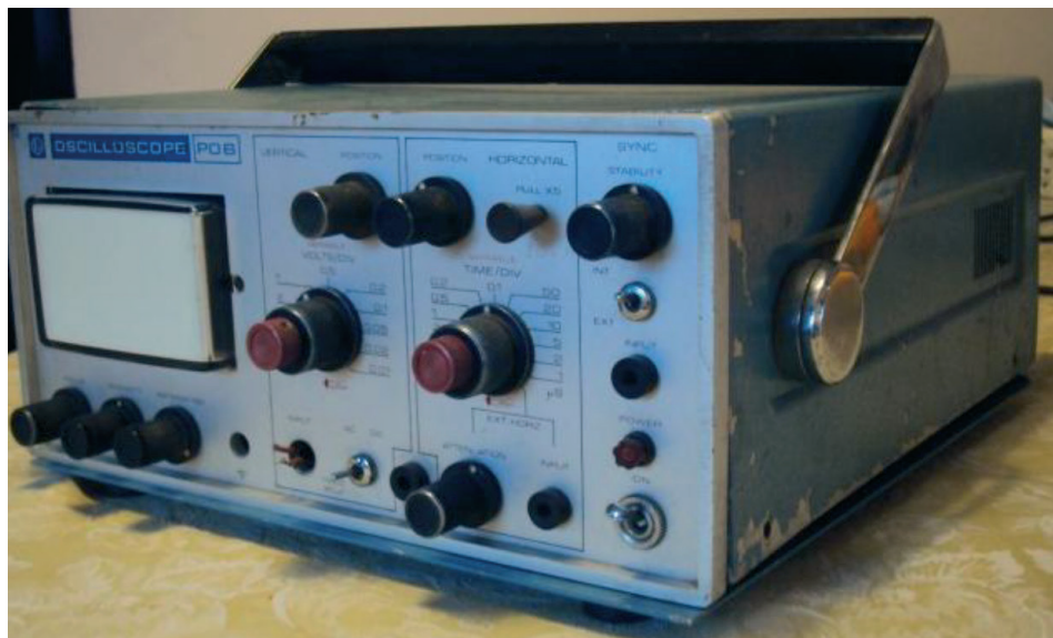
Sl. 8.: Osciloskop tvornice EI Niš oznake PO6
