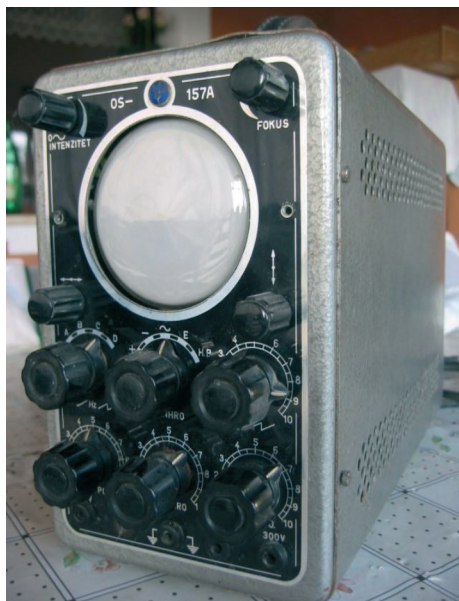
Sl. 2.: Osciloskop tvornice RIZ oznake OS-157A, proizveden 1957. godine
