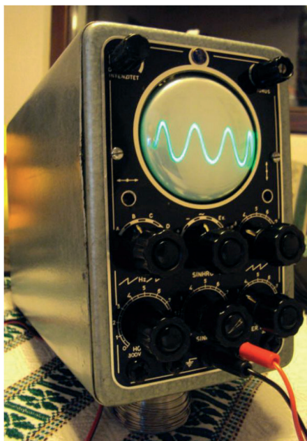
Sl. 1.: Osciloskop zagrebačke tvornice RIZ oznake OS-155, proizveden 1955. godine
