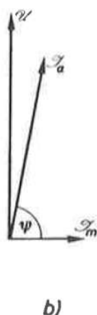
Sl. 15.52. Poredni motor na mreži izmjeničnog napona: a) shema, b) fazori struja
