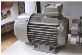
Slika 12.9. Trofazni asinkroni motor
