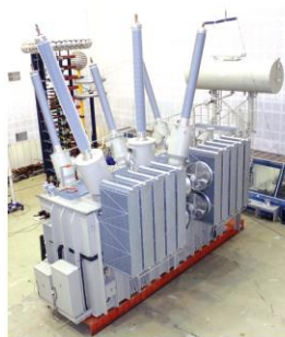
Slika 13.17. 1000 MVA, 420/300/10,5 kV, Ukupna masa 325 t – Proizvodnja: KONČAR KPT – Zagreb
