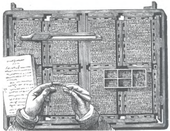
Ručno slaganje teksta od pojedinačnih olovni slova (ilustracija iz Novovjekih izuma II. iz 1883. god.)
