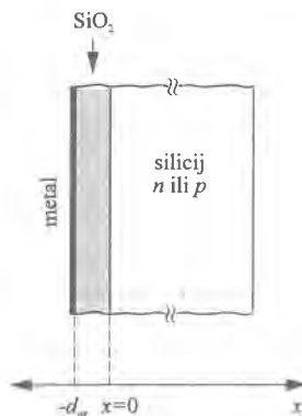
Slika 11.5. MOS-struktura za analizu napona praga
