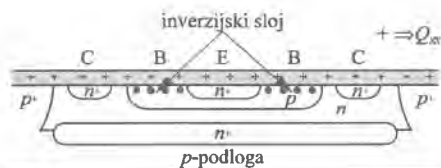
Slika 11.21. Pojava inverzijskih slojeva na površini p -baze nnp -tranzistora
