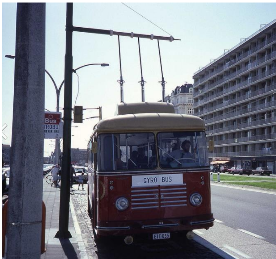
Slika 21. Gyrobus koji je za pogon između dvije stanice koristio energiju pohranjenu u zamašnjaku [34]
