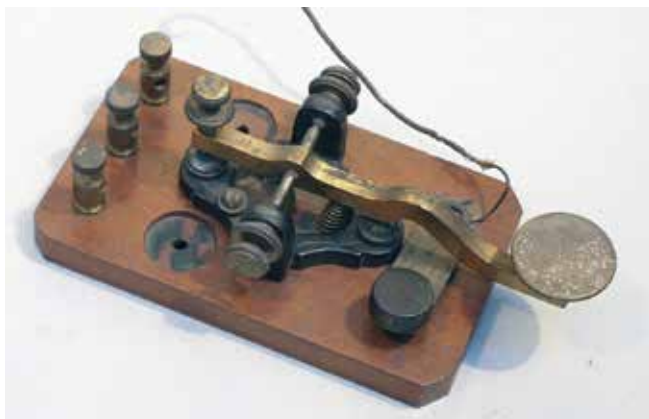
Slika 4.: Telegrafski uređaj s tipkalom za odašiljanje znakova
