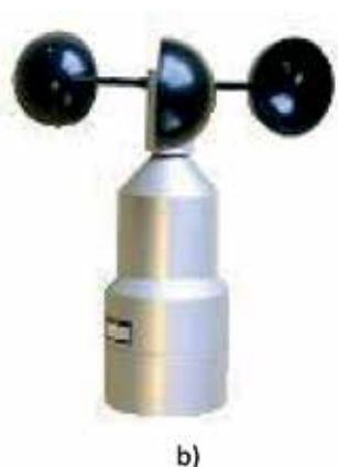
Slika 23.: a) Faustov mlin s trokutastim krilima , b) vjetromjer
