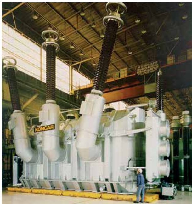
Slika 8.: Transformator najveće snage dosad proizveden – generatorski transformator od 725 MVA, 410 \pm 3 \% / 21 \text{ kV} , isporučen 1985. godine u Termoelektranu Nikola Tesla u Obrenovcu, Srbija
