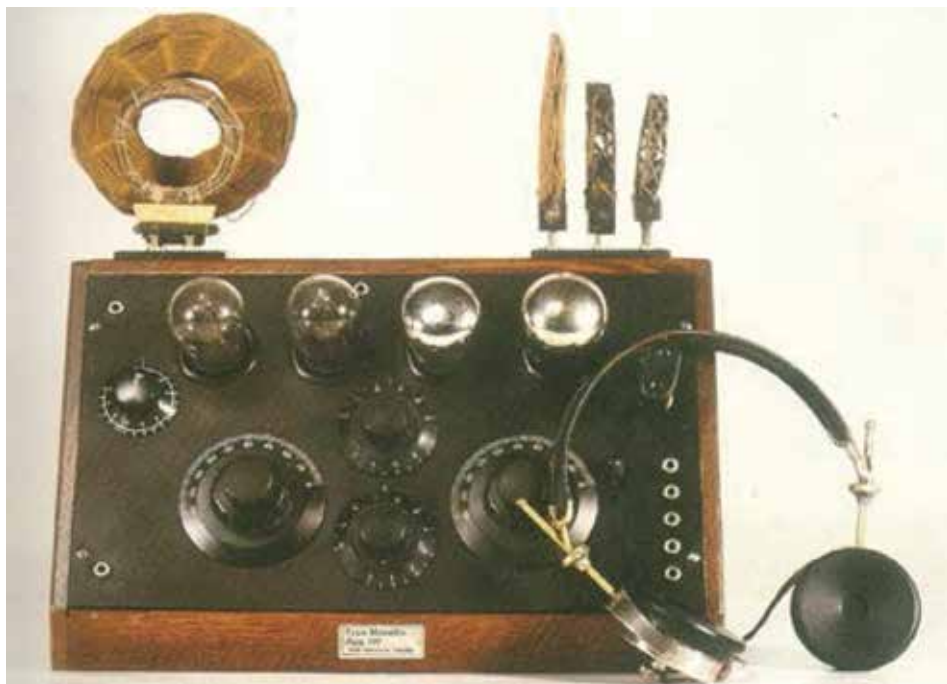
Slika 6.: Radijski prijamnik s početka 1920-ih godina, s elektronskim cijevima, pomičnim zavojnicama, uz prijam na slušalice
