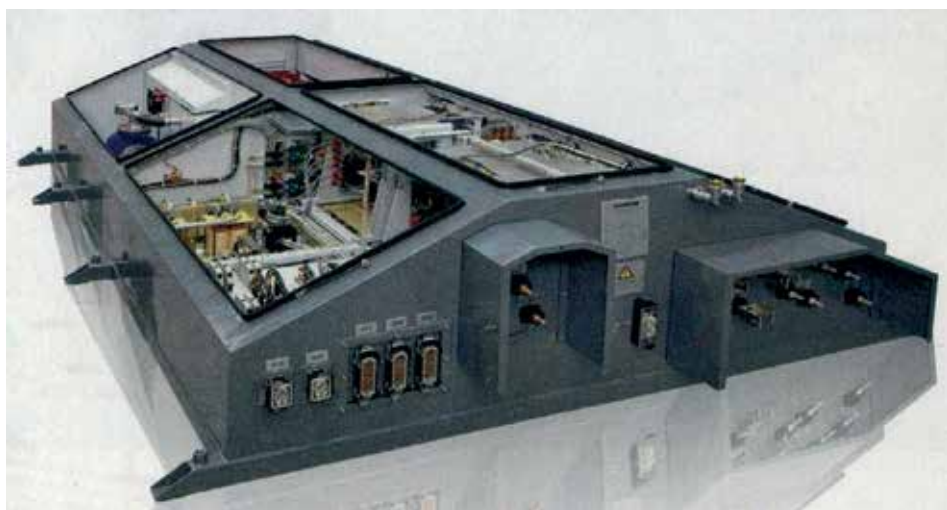
Slika 18.: Pretvarač s bipolarnim tranzistorima s izoliranom upravljačkom elektrodom (IGBT) za napajanje vučnih motora elektromotornog vlaka
