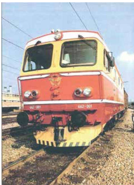
Slika 5.: Tiristorska lokomotiva snage 4400 kW, napona napajanja 25 kV/50 Hz, maksimalne brzine 160 km/h, do 1990. isporučeno 16 lokomotiva ( Rade Končar )
