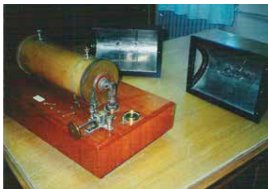
Slika 2.: Koherer za Hertzove pokuse
