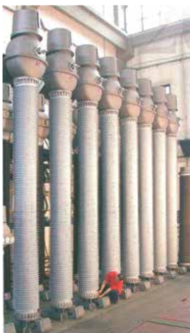
Slika 9.: Strujni mjerni transformatori za rad na mrežama napona 765 kV (2003.)
