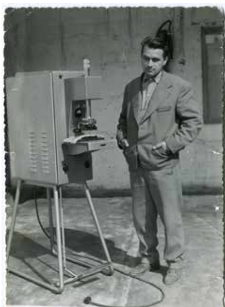
Sl. 1.: Lovre Savin i njegova konstrukcija stroja za visokofrekvencijsko varenje plastike
