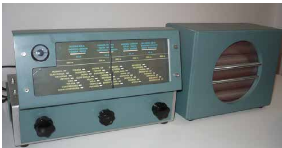
Sl. 11.: Savinov četverocijevni superheterodinski prijemnik sa zvučnikom
