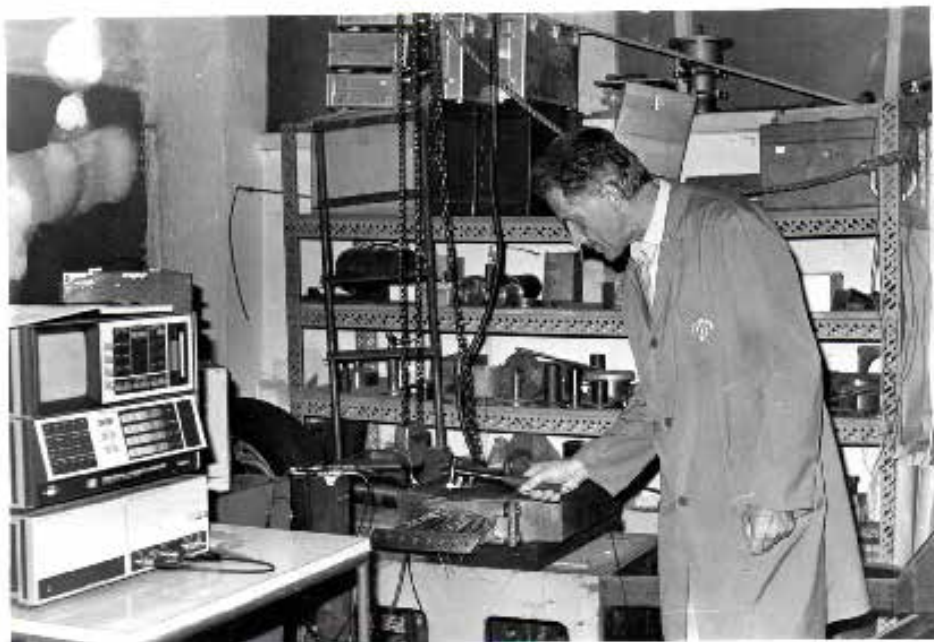
Sl. 6. Ispitivanje lopatica FFT metodom u laboratoriju 1986.
