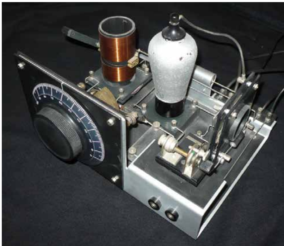
Sl. 4.: Prvi refleksni jednocijevni prijemnik s kristalnim detektorom Lovre Savina
