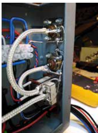
Sl. 15.: Dio odašiljača namijenjen distribuciji napajanja i upravljanju prijem/predaja
