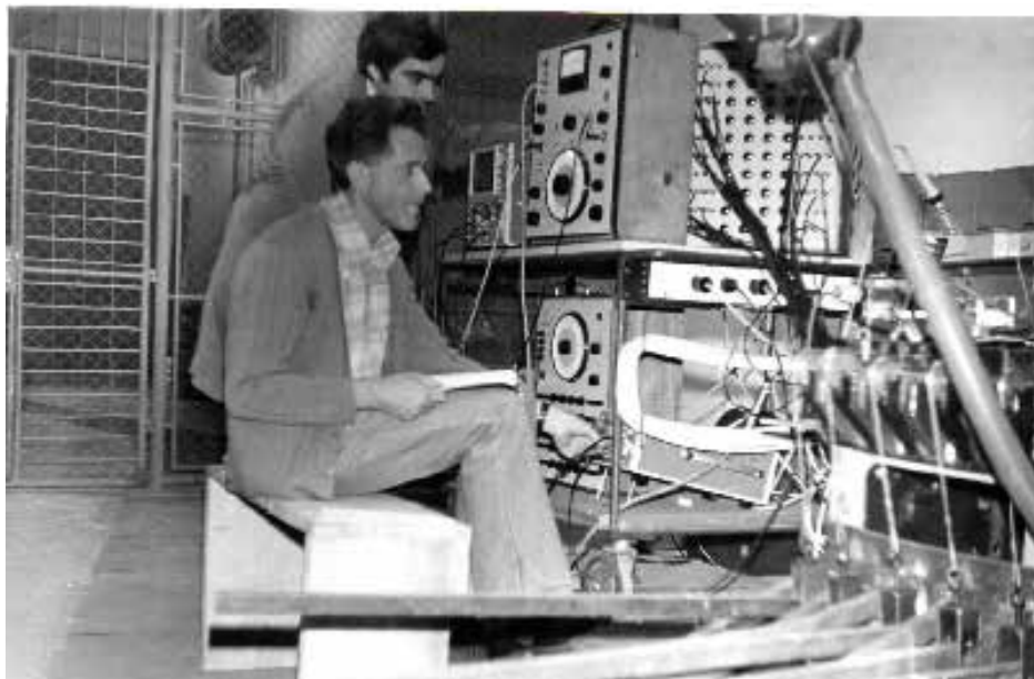
Sl. 5. Ispitivanje prigušenja lopatica s prigušnom žicom u posebnom laboratoriju 1979. Na slici Anton Fudurić i Mirko Butković
