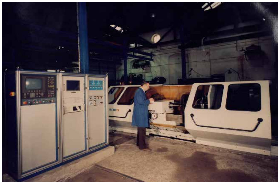
Sl. 12. Horizontalni stroj za balansiranje tip SBH 3000 CNC, firme ENIN Karlovac (slijednica Instituta Jugoturbine ) isporučen 1994. Gredelju Zagreb , za automatsko balansiranje vagonских osovina s kotačima
