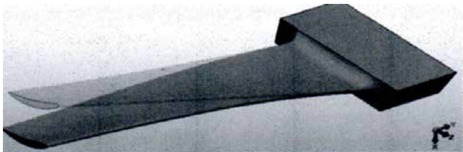
Sl. 9. Prva forma vibriranja dobivena eksperimentalnom metodom.
