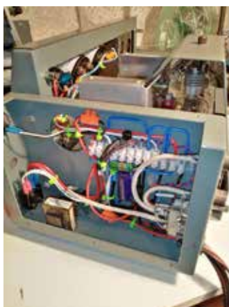
Sl. 15.: Dio odašiljača namijenjen distribuciji napajanja i upravljanju prijem/predaja
