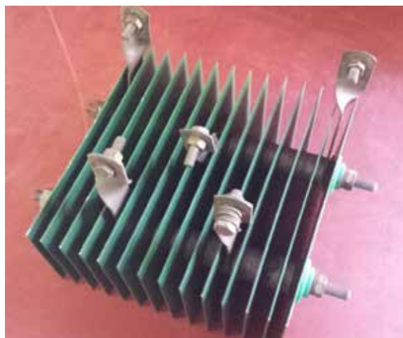
Slika 10. Selenski ispravljač tvrtke ISKRA. Očito se radi o ispravljaču u trofaznom mosnom spoju. U sredini su tri priključka za trofaznu mrežu, a na krajevima su dva priključka za istosmjerno trošilo. (oko 1950.) [6]
