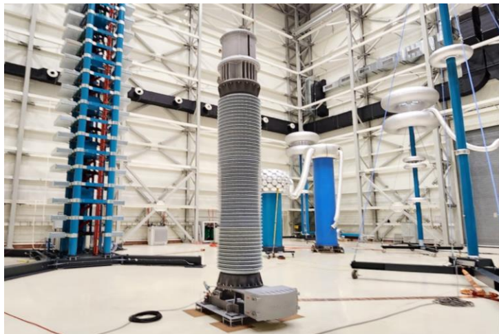
Naponski transformator velike snage 550 kV / 250 kVA
