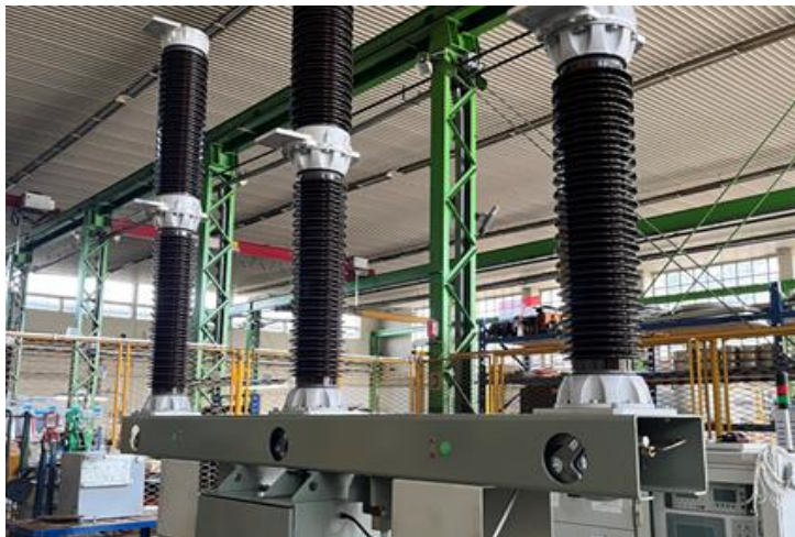
Tropolni 145 kV prekidač (ugovor 50+30 komada) s motorno-opružnim pogonom EU tržište
